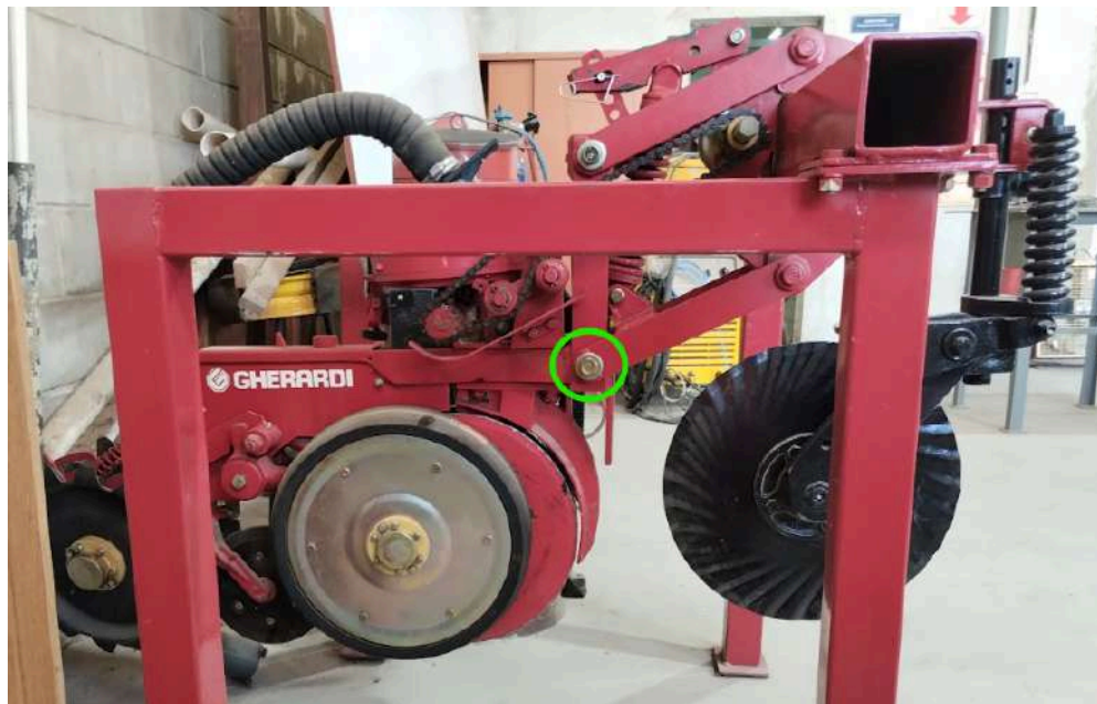
Figura 3-15: Tren de siembra - eje inferior paralelogramo deformable.
