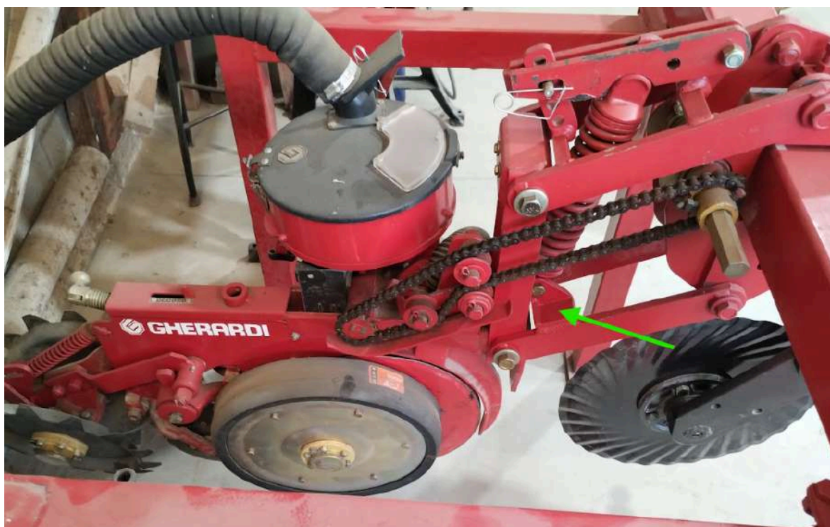
Figura 3-16: Tren de siembra - ubicación de sensores en ensayo a campo.
