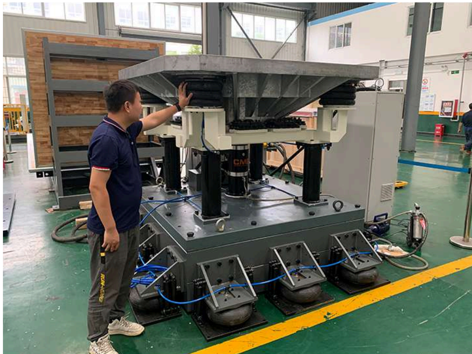
Figura 2-3: Tamaño de shaker hidráulico comparado con una persona[11].
