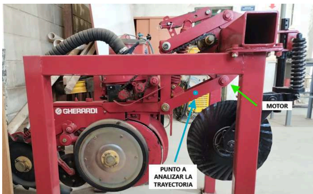
Figura 3-18: Tren de siembra - verificación de trayectoria.
