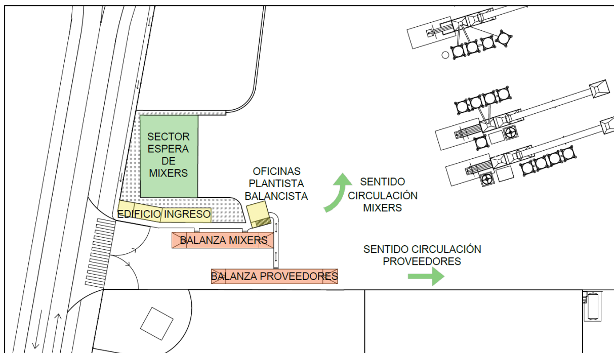
Figura 7.3.5.1. Nueva acceso a planta H° sobre frente OESTE.
