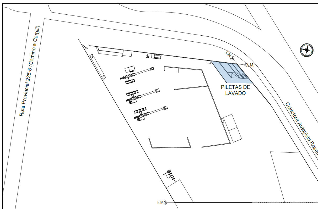
Figura 7.3.4.1. Disposición actual de piletas de lavado.
