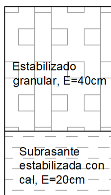
Figura 10.2.4. Perfil adoptado estabilizado granular.
