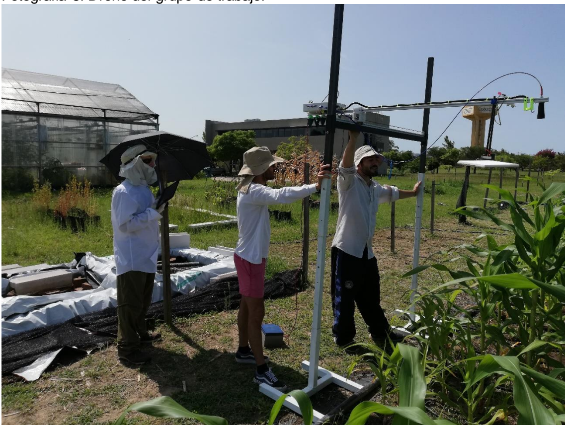
Fotografía 9. En ensayo de maíz en IAL, Santa Fe, tomando datos espectrométricos de manera semiautomática.
