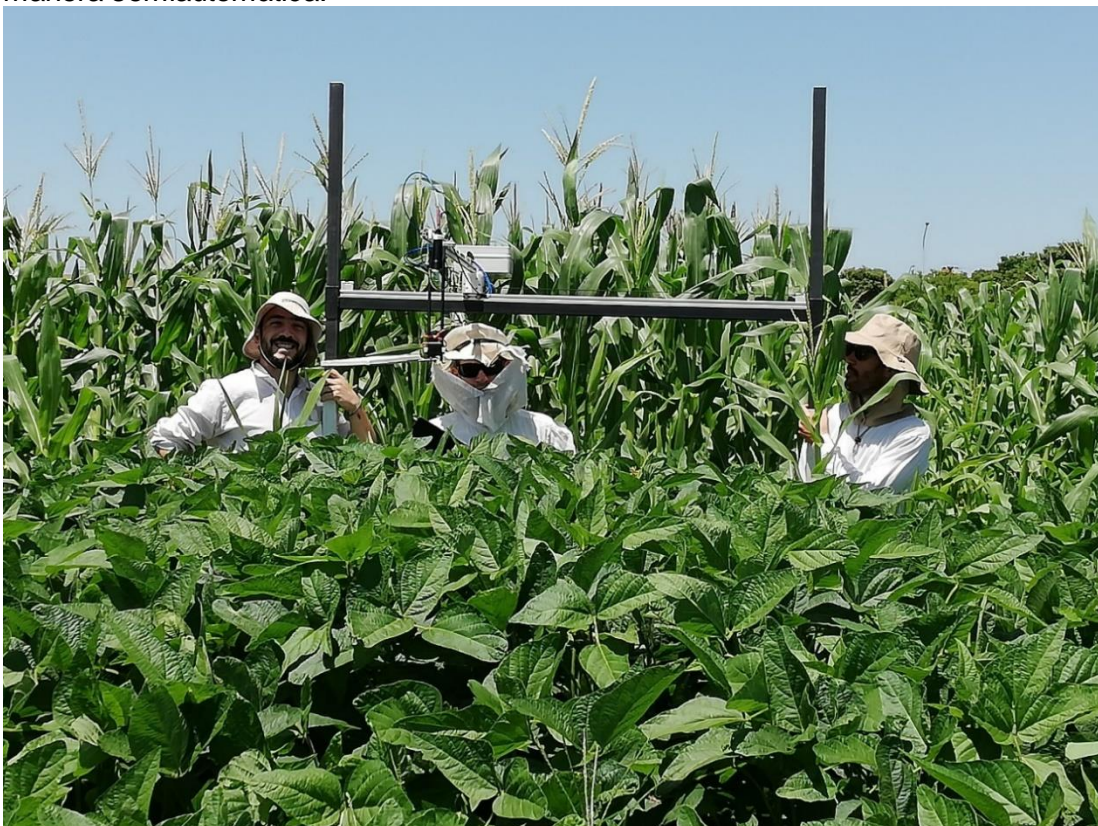
Fotografía 11. En ensayo de soja en IAL, Santa Fe, tomando datos espectrométricos de manera semiautomática.
