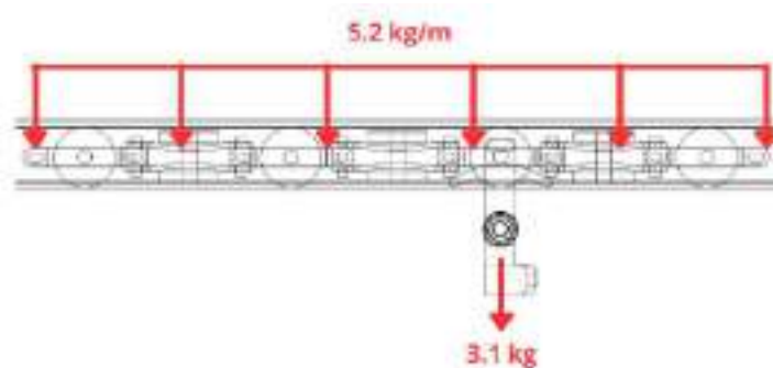
Figura 5-99: Distribución de carga en gancho de empuje.
