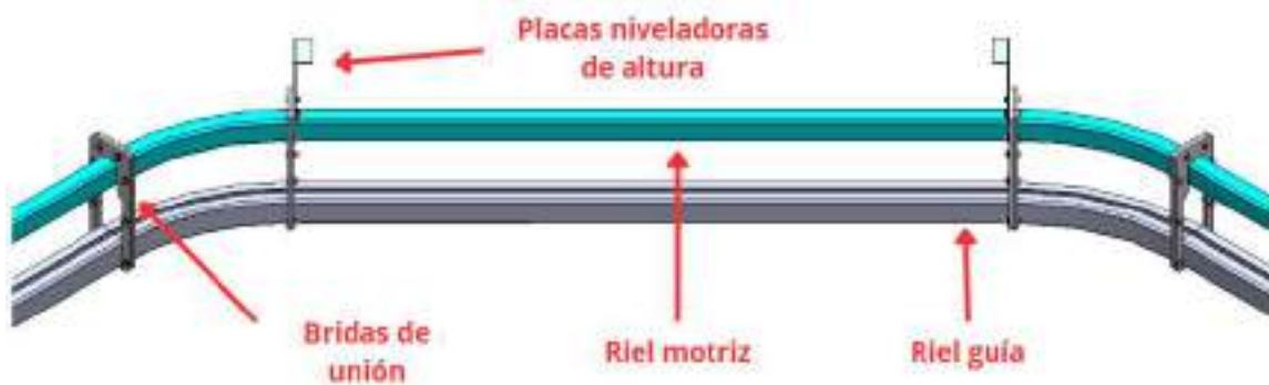
Figura 5-30: Montaje de rieles guía y motriz.
