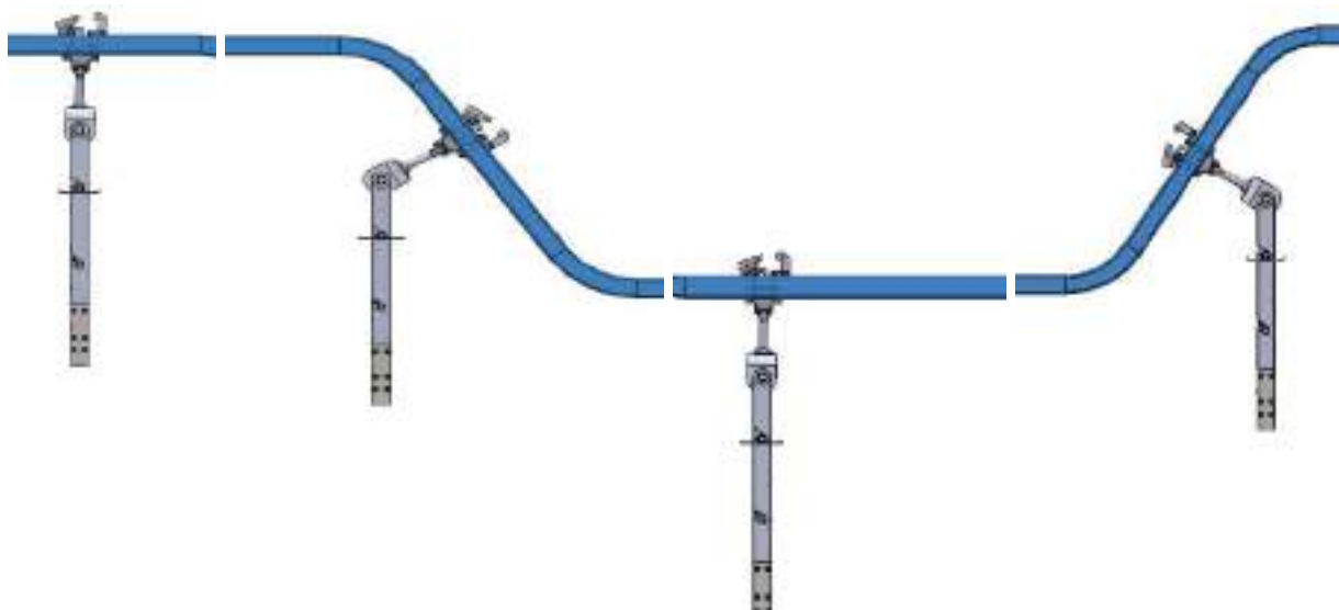
Figura 5-62: Secuencia de bajada/subida de percha.
