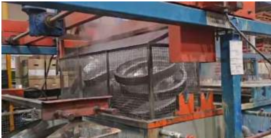
Figura 2-3: Secuencia de sumergir las canastas en las correspondientes cubas.
