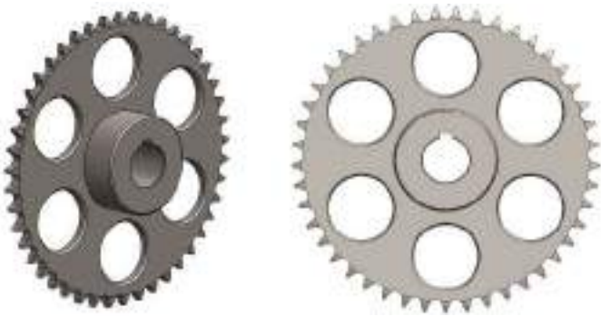
Figura 5-148: Diseño final de corona de punta.
