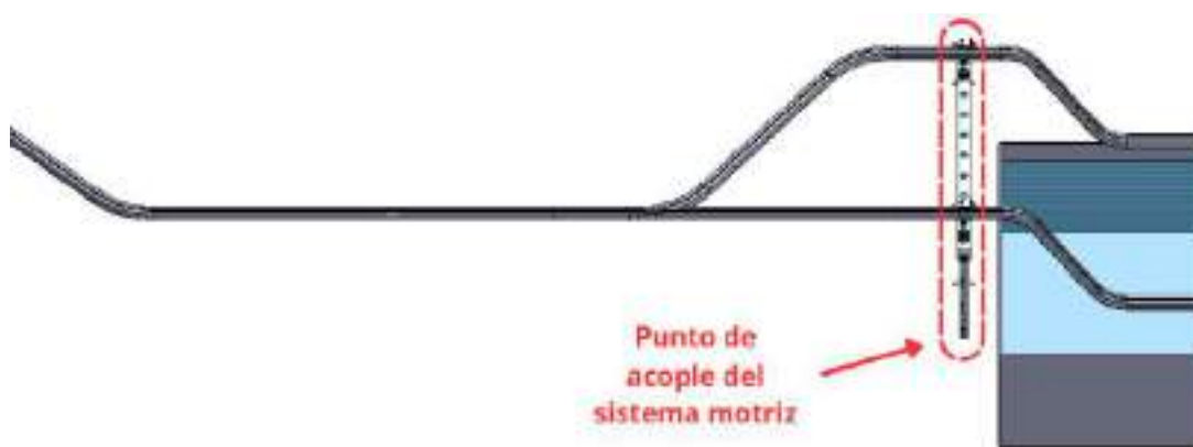
Figura 5-76: Zona de acople del carro al sistema motriz.
