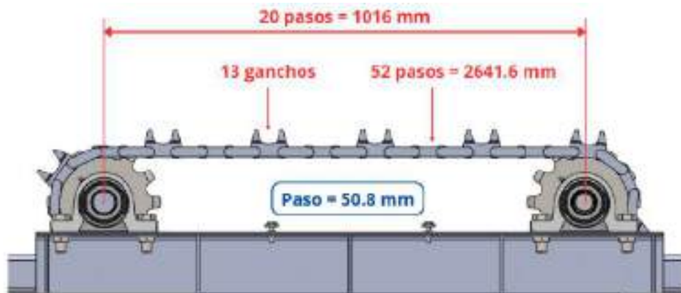
Figura 5-91: Distancia entre ejes y longitud de cadena.
