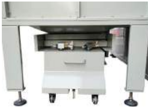
Figura 5-10: Colector acumulador de polvo recuperado en los filtros.
