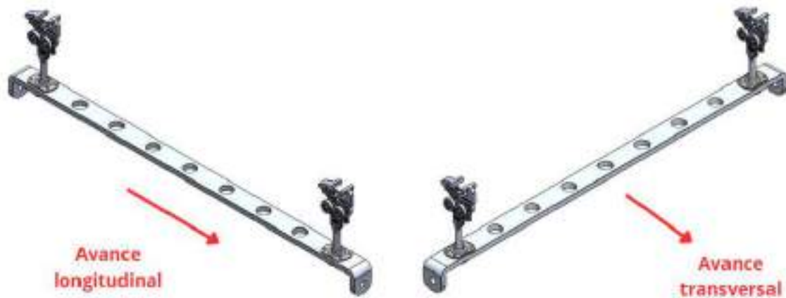
Figura 5-35: Distintos avances de percha.
