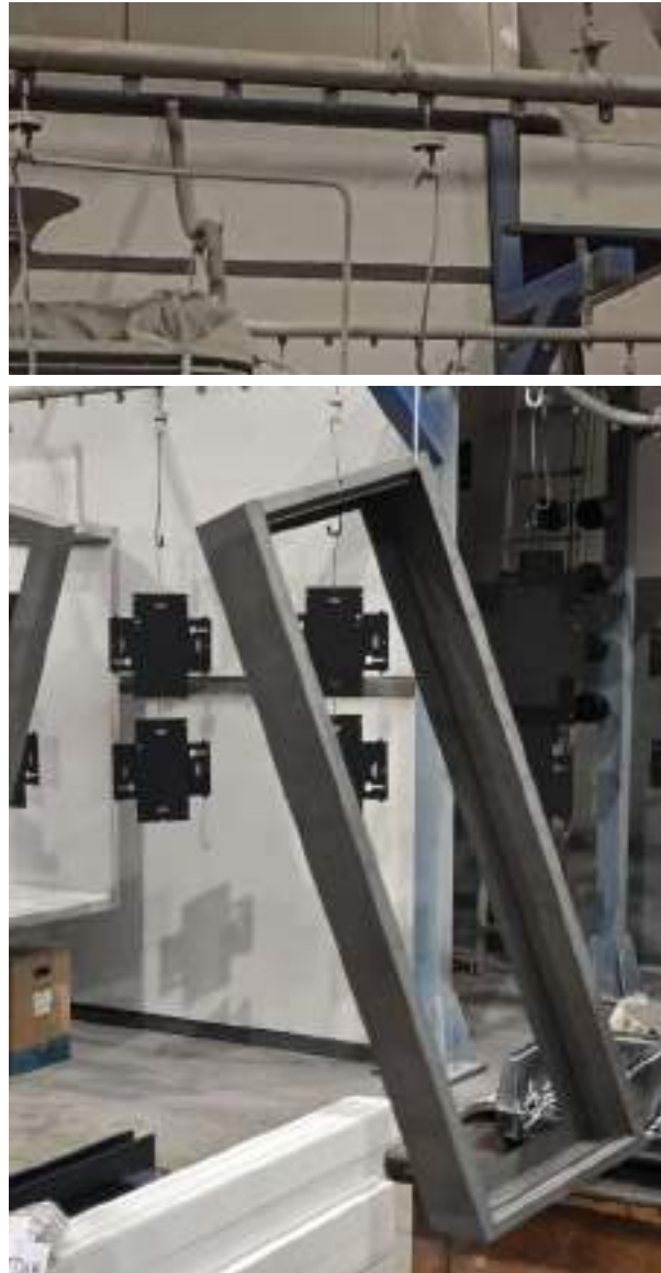
Figura 2-5: Cadena de transporte con ganchos para colgar las piezas a pintar.
