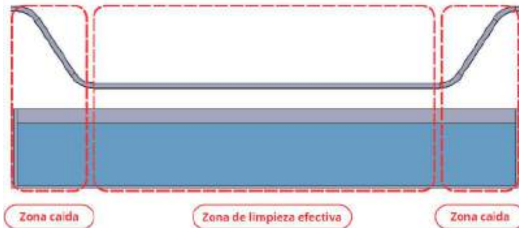
Figura 5-48: Tramo de riel sobre cuba.
