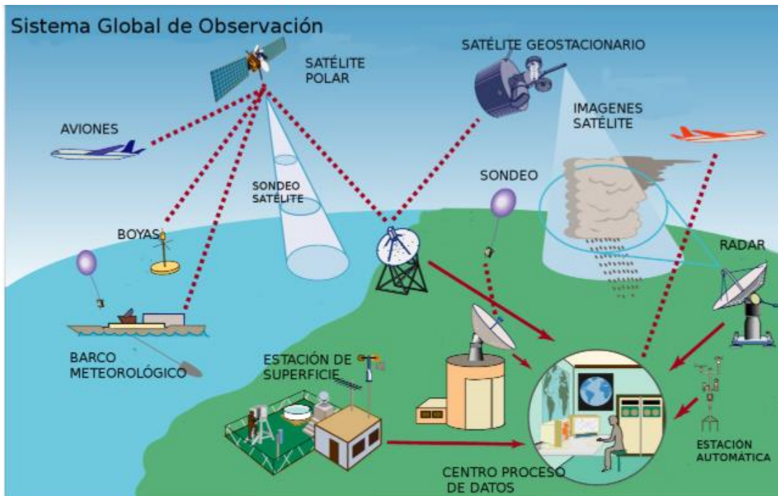
Figura 5. Sistema Global de Observación. Las observaciones se transmiten en tiempo casi real y son utilizadas por los modelos para hacer una estimación del estado de la atmósfera (análisis). Fuente: Organización Meteorológica Mundial ( https://wmo.int/ )
