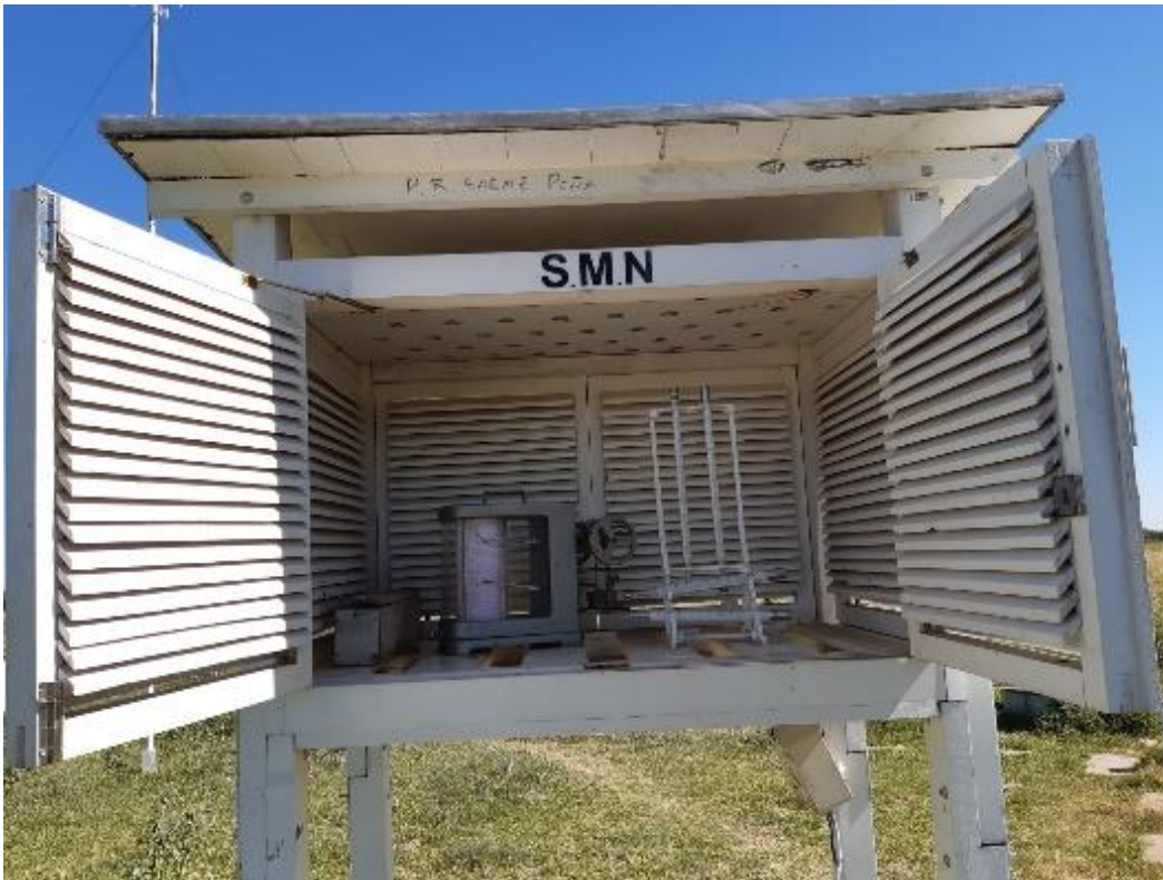
Figura 6. Abrigo Meteorológico de la Estación Meteorológica de Presidencia Roque Sáenz Peña. (Imagen propia)
