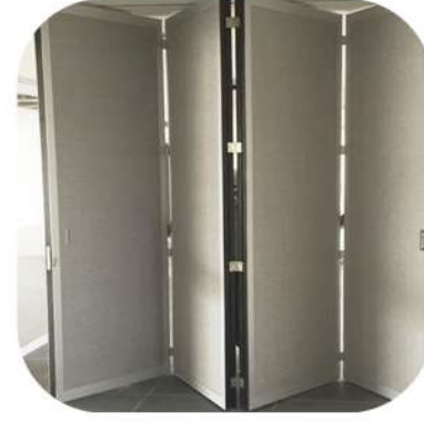
Paredes moviles acústicas -Marcos estructurales -Ancho máximo panel 1.20m . Espesor 97mm. -Sellos inferiores y superiores cierran herméticamente el vano
