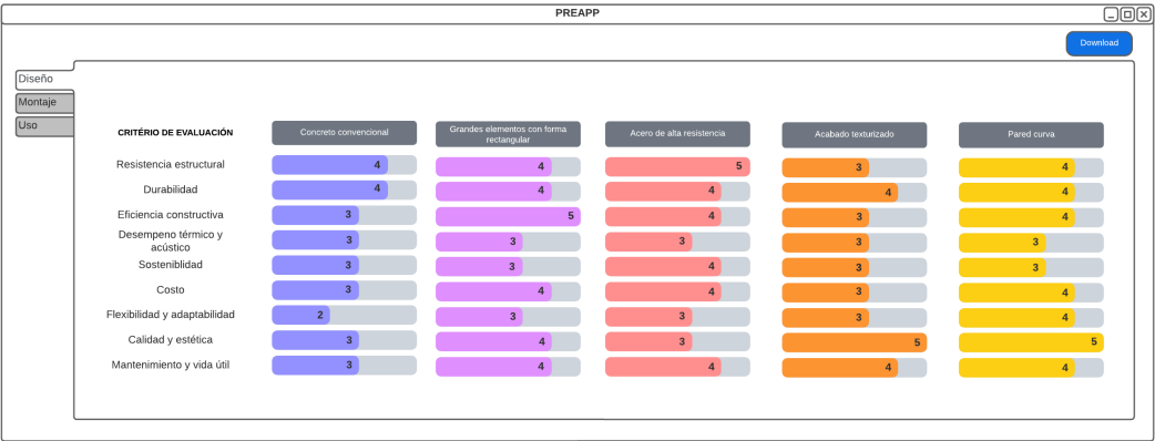
Ilustración 62 – Interfaz del plugin PREAPP presentando las recomendaciones de diseño, estructuradas según los criterios de evaluación en una escala de 0 a 5. También presenta la opción de “descargar” para descargar el informe del análisis. Fuente: PREAPP, elaboración propia.
