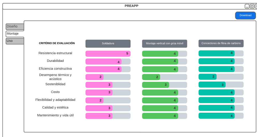
Ilustración 63 – Interfaz del plugin PREAPP presentando las recomendaciones de montaje, estructuradas según los criterios de evaluación en una escala de 0 a 5. También presenta la opción de “download” para descargar el informe del análisis. Fuente: PREAPP, elaboración propia.
