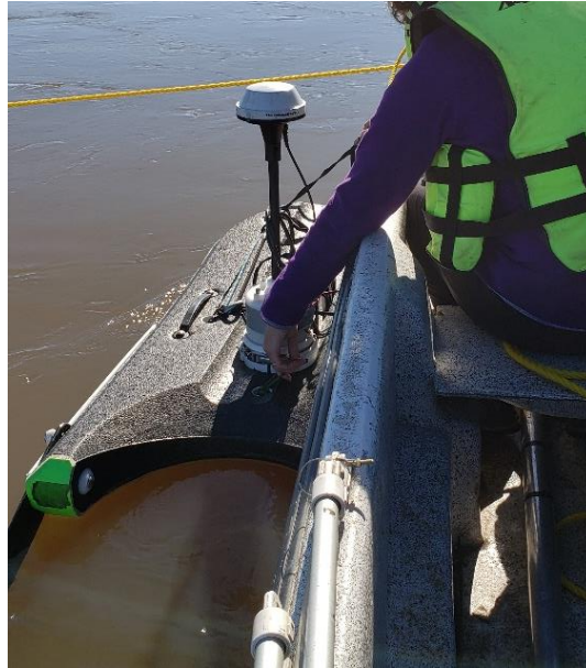
Figura 5.7.- ADCP Sontek M9 en su Hydroboard .
