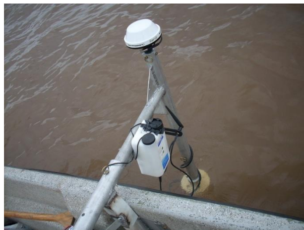
Figura 5.6.- ADCP Sontek M9 adosado a una embarcación.
