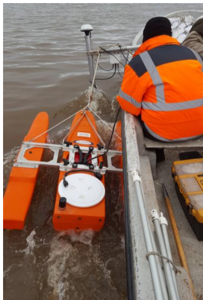
Figura 5.9.- ADCP Teldeyne RDI Río Grande montado en un trimarán.
