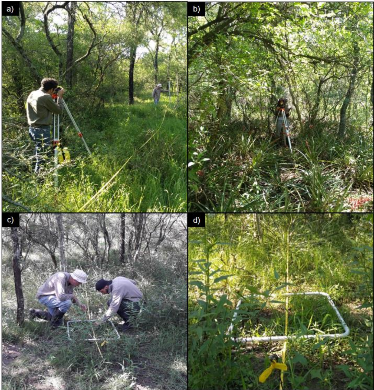
Figura 4.2. Imágenes ilustrativas del muestreo de la altura topográfica con nivel óptico (a, b) y de la vegetación en las parcelitas de 0,5 m 2 (c, d) a cada metro de la transecta.
