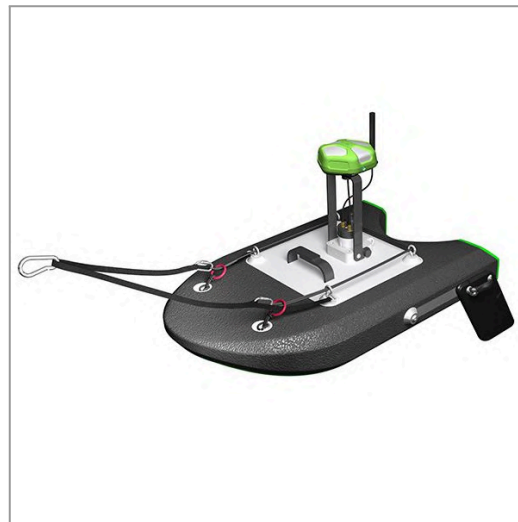
Figura 5.43. Plataforma móvil para el ADCP.
