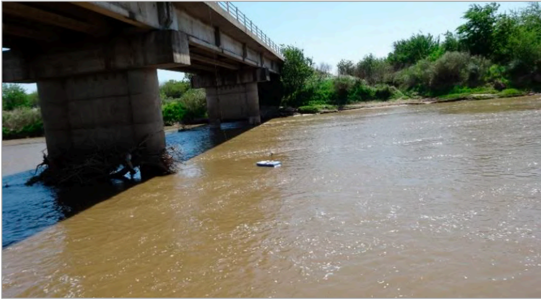
Figura 5.45. ADCP posicionándose en RP15, Cruz Alta (Díaz Losada et al., 2013-2018).
