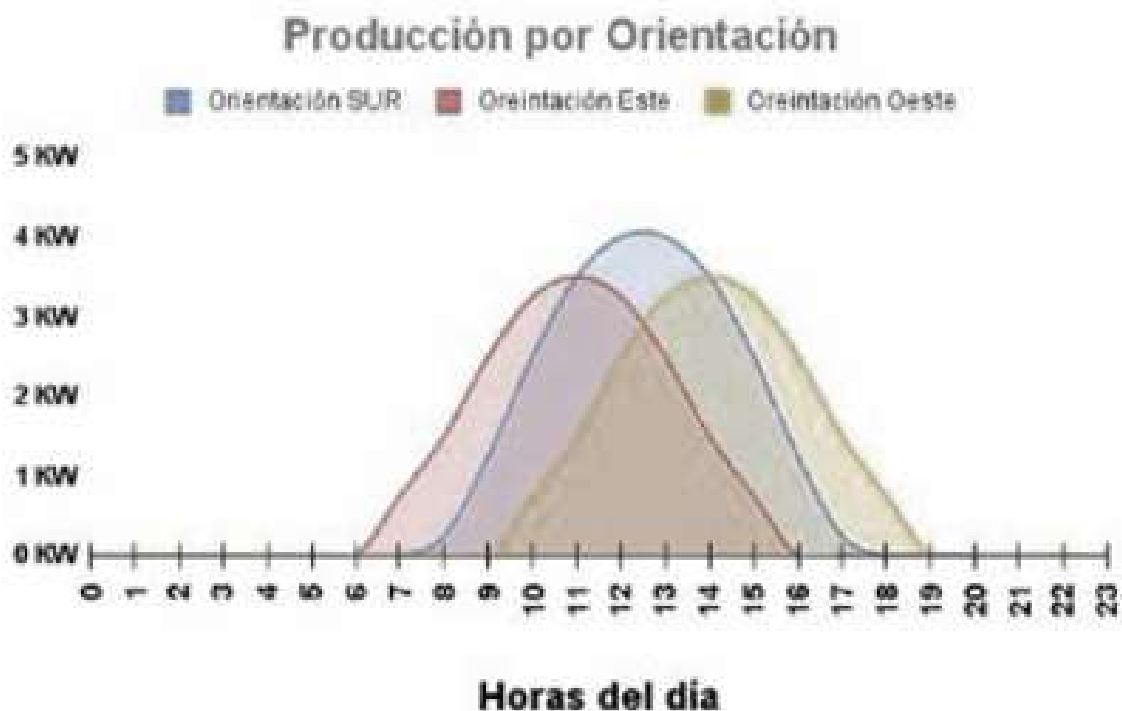
FIGURA 11 - Desplazamiento de curva de generación – Fuente: AulaFacil.com
