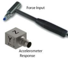
Figura 1: Elementos para ensayo de vibración. Martillo (force input) y acelerómetro (accelerometer response)
