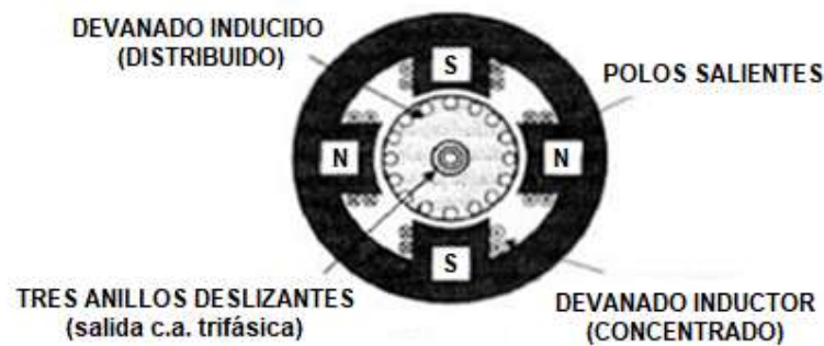
Máquina sincrónica de baja potencia con el inducido en el rotor
