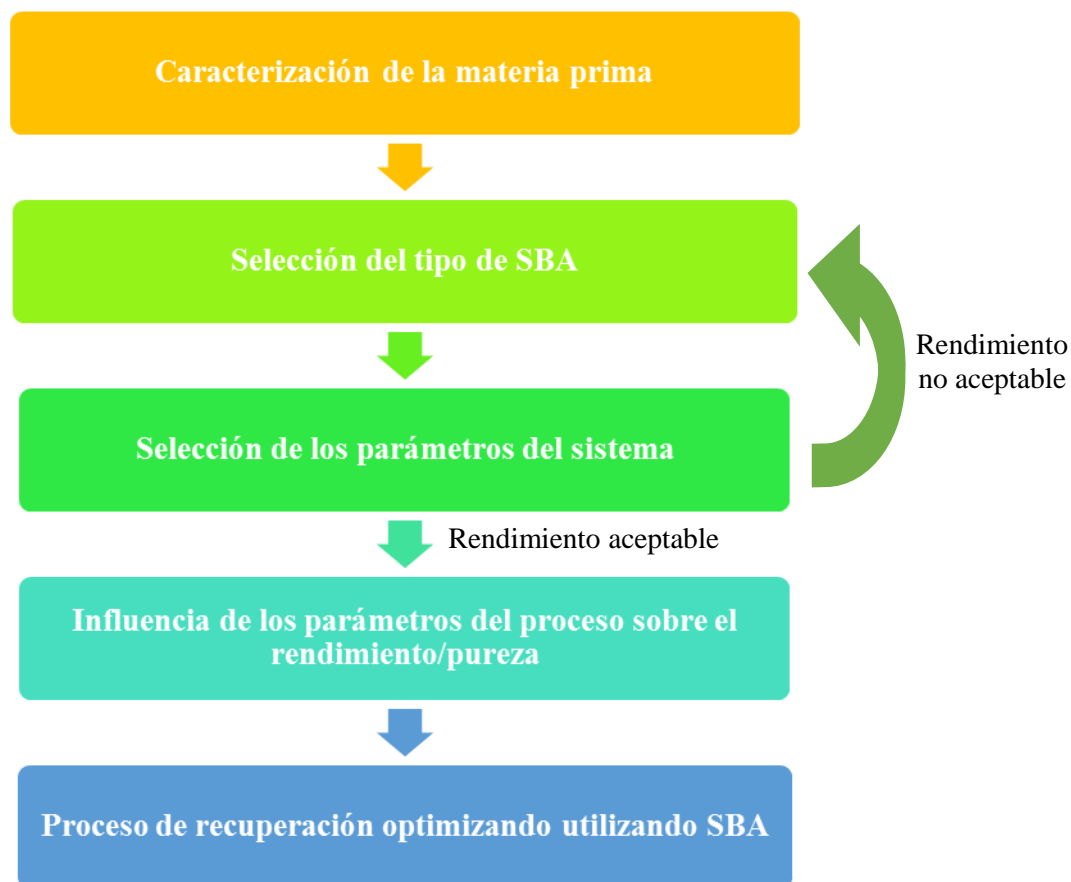
Figura 1.15: Representación simplificada de la estrategia propuesta para desarrollo y diseño del proceso de purificación de biomoléculas utilizando SBA adaptado de (Benavides and Rito-Palomares 2008).
