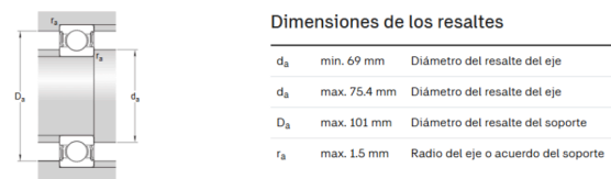
Figura 4-34: dimensiones rodamiento.
