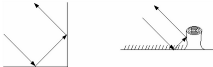
Figura 17. Mecanismos de retrodispersión: doble rebote. Fuente: SARMAP (2008).
