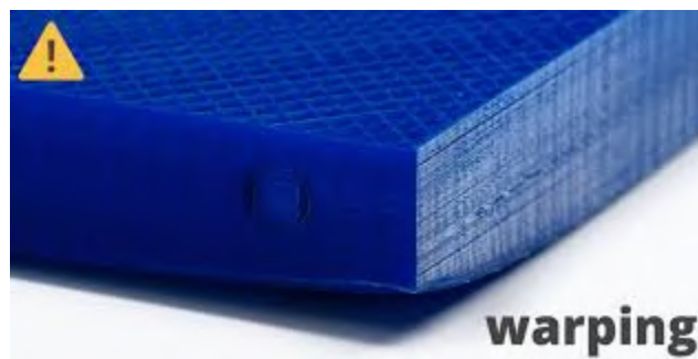
Figura 1-8: Warping en Impresión 3D [17]
