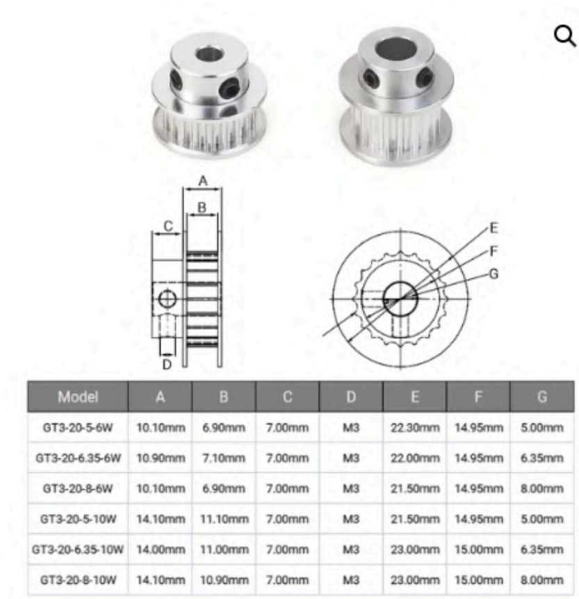
Figura 2-9: Dimensiones de polea GT3 (GT3-20-8-10W).[25]
