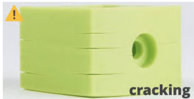
Figura 1-9: Cracking en impresión 3D [17]
