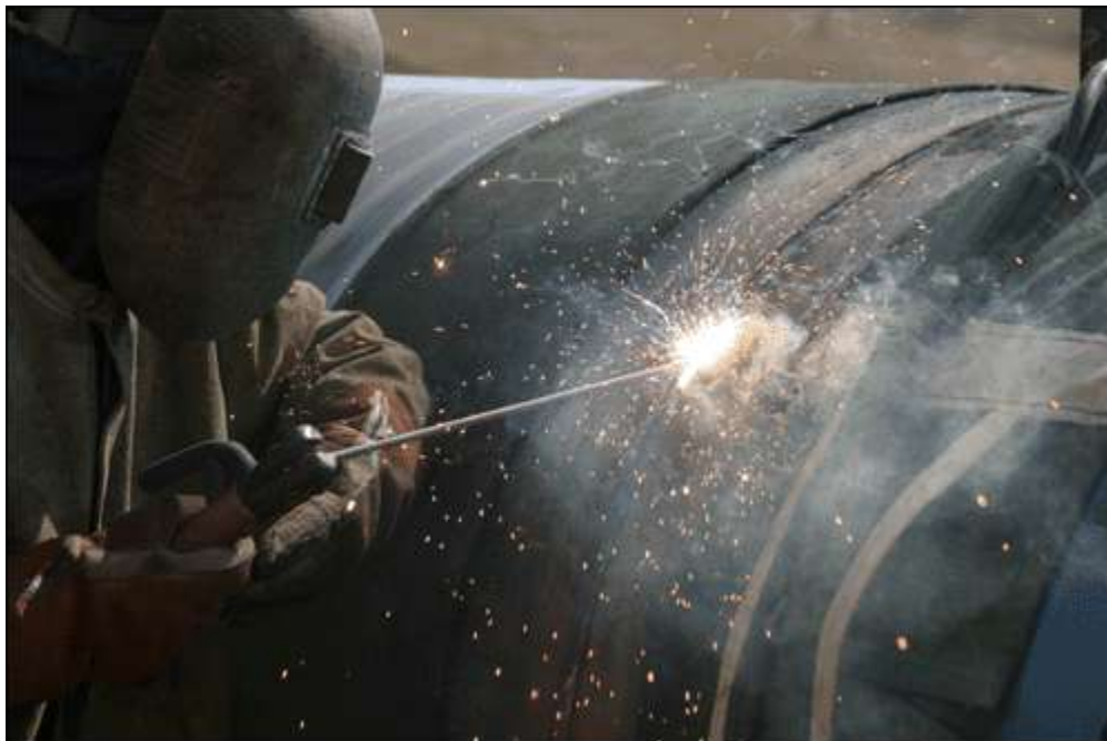
Figura 1-2: Proceso de recargue duro por soldadura por arco con electrodo revestido.
