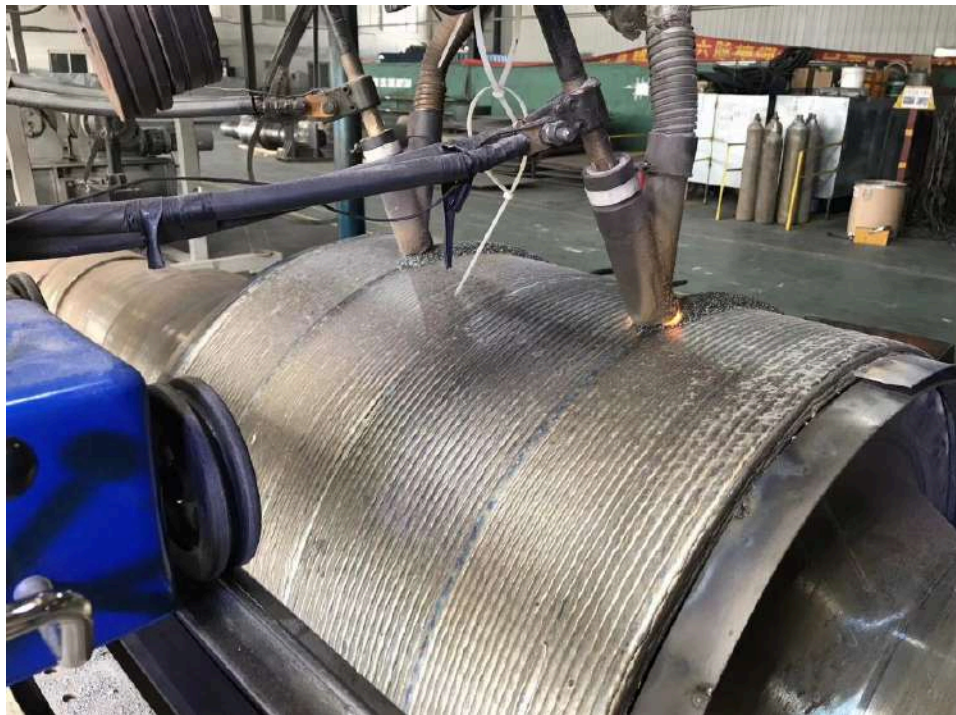
Figura 1-1: Proceso de recargue duro por soldadura de arco sumergido. [ Fuente: Jinan Lit. Industry ]
