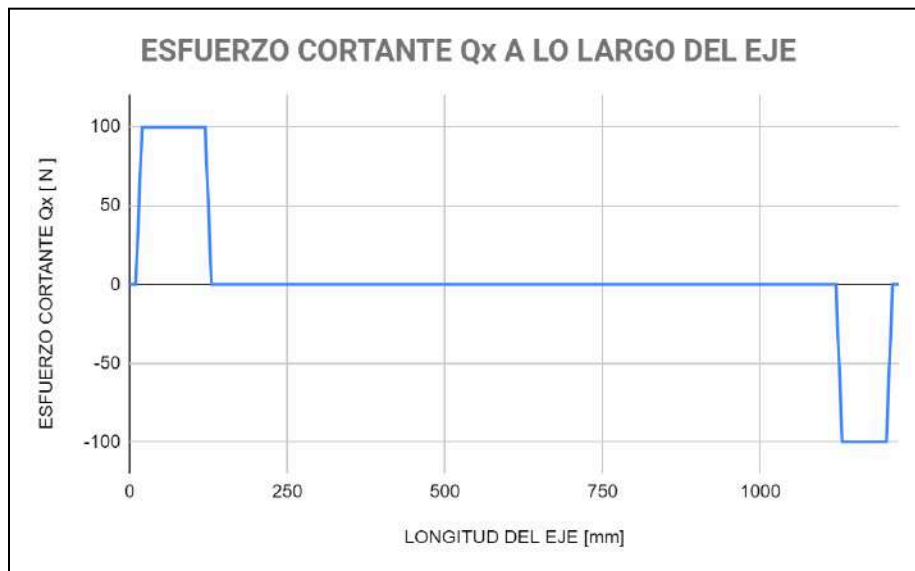
Figura A-31: Diagrama de esfuerzo cortante Q_x a lo largo del eje horizontal. [ Fuente: propia ]
