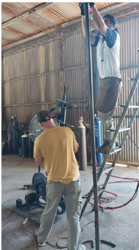
Figura 2-6: Posicionamiento del tornillo sin fin. [ Fuente: Propia - Acorazados Santa Clara ]
