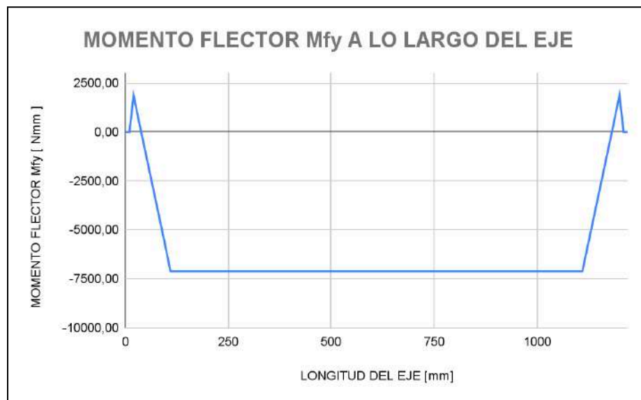
Figura A-35: Diagrama de momento flector M_{fy} a lo largo del eje horizontal. [ Fuente: propia ]
