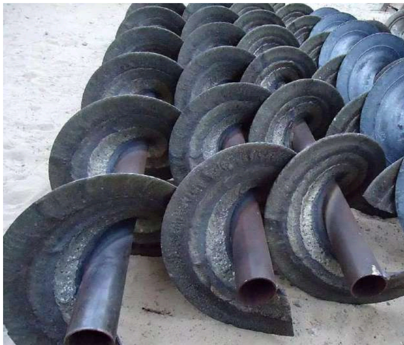
Figura 2-4: Revestimiento total de la hélice. [ Fuente: Propato Cementados ]
