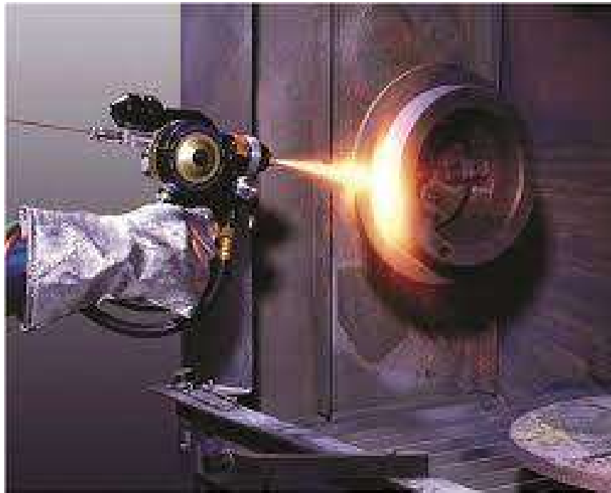
Figura 1-10: Proceso de recargue duro por thermal spray. [ Fuente: The Fabricator ]
