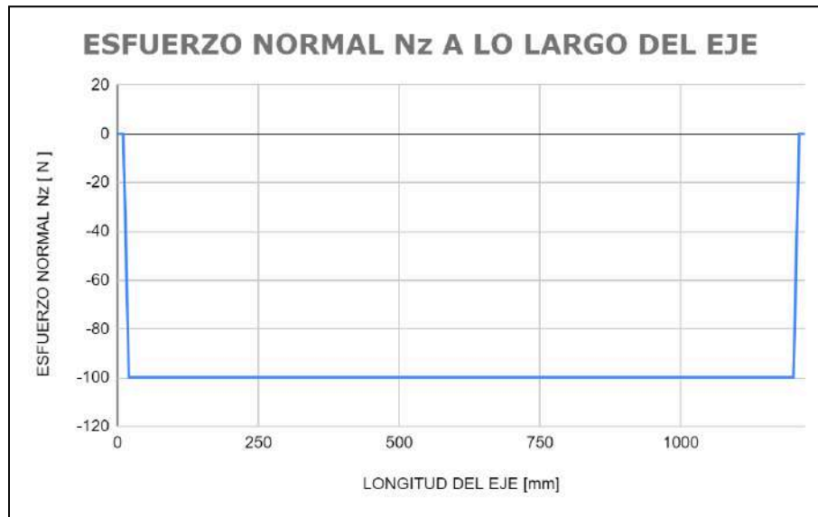
Figura A-30: Diagrama de esfuerzo normal N_z a lo largo del eje horizontal. [ Fuente: propia ]
