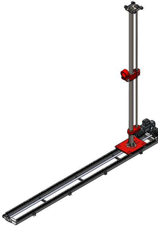
Figura 3-10: Conjunto 03 - Sistema de posicionamiento del sinfín. [ Fuente: propia ]
