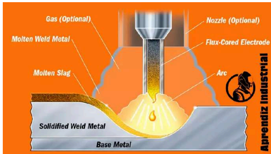
Figura 1-7: Esquema del proceso de soldadura FCAW. [ Fuente: Tecnología en soldadura ]
