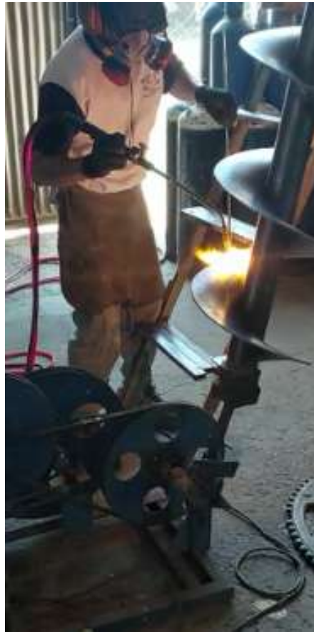
Figura 2-7: Proceso semi-automático de recargue duro. [ Fuente: Propia - Acorazados Santa Clara ]
