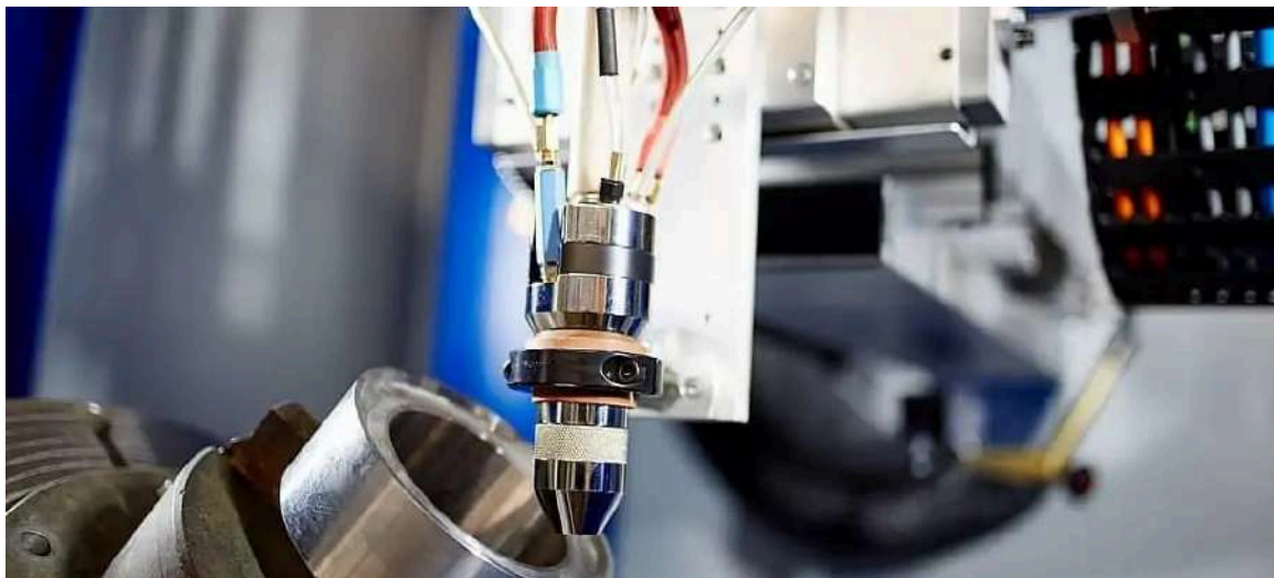
Figura 1-3: Proceso de recargue duro por soldadura por arco de tungsteno con gas. [ Fuente: Waldrun ]
