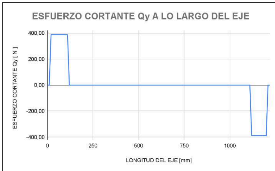
Figura A-32: Diagrama de esfuerzo cortante Q_y a lo largo del eje horizontal. [ Fuente: propia ]
