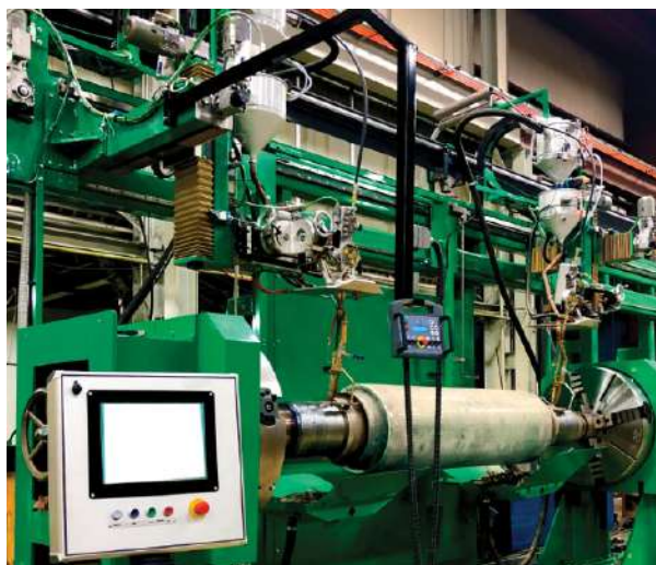
Figura 1-16: Equipo automático de aporte con soldadura tipo SAW. [ Fuente:Welding Alloys ]
