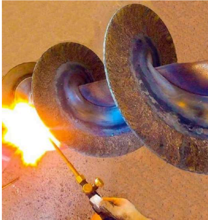
Figura 1-8: Proceso de recargue duro por soldadura oxiacetilénica. [ Fuente: Propato Cementados ]
