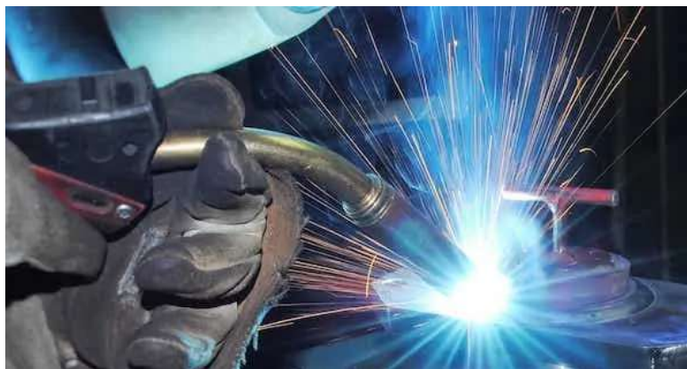
Figura 1-5: Proceso de recargue duro por soldadura por arco de tungsteno con gas.
