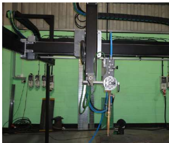
Figura 1-17: Equipo automático de aporte en H con soldadura tipo GMAW. [ Fuente:Welding Alloys ]
