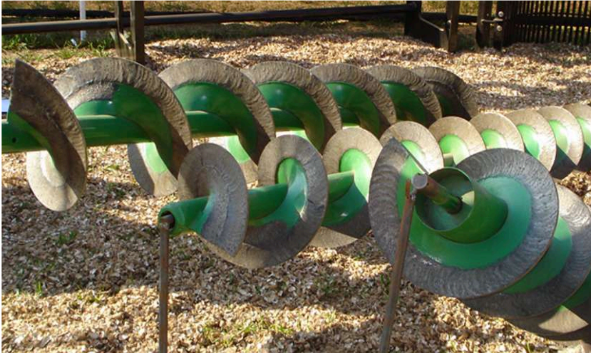
Figura 2-5: Revestimiento parcial de la hélice. [ Fuente: Cementados Río Tercero ]
