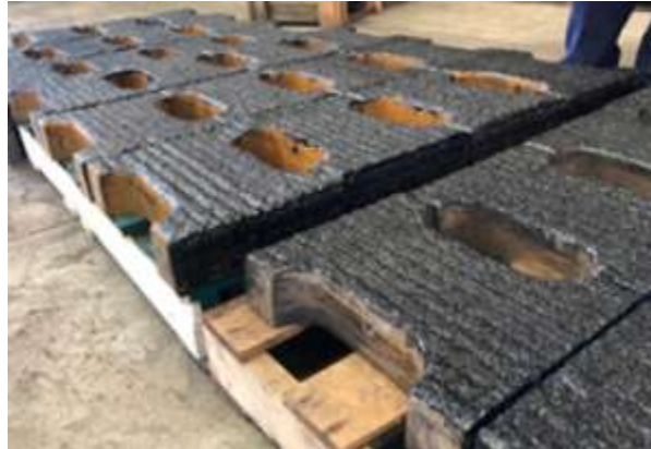
Figura 1-6: Piezas con recargue duro a través del proceso GMAW. [ Fuente: Codinter ]
