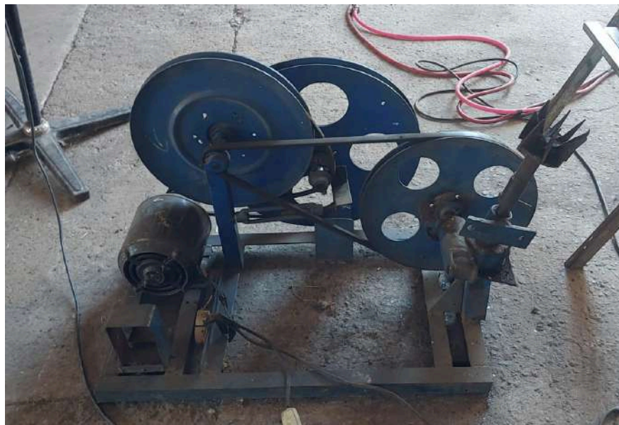
Figura 1-11: Automatismo para la rotación del tornillo sin fin. [ Fuente: Propia - Acorazados Santa Clara ]
