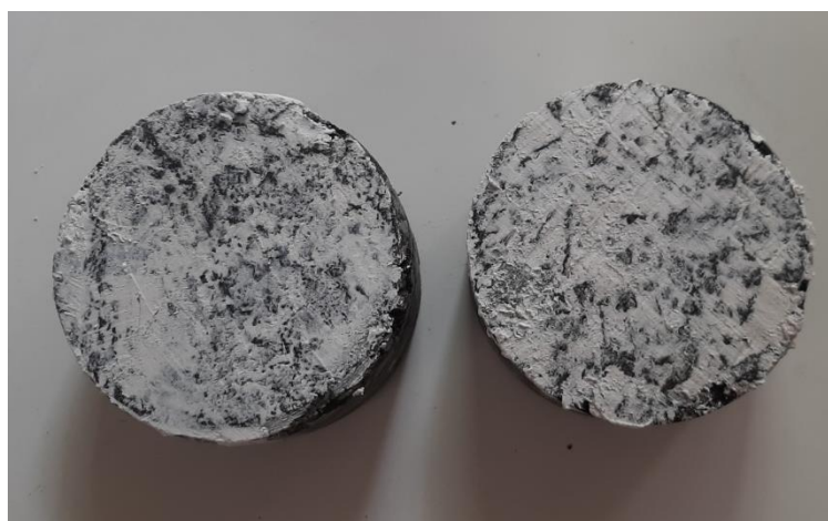
Figura 21. Apariencia de las probetas luego de aplicado el yeso.
