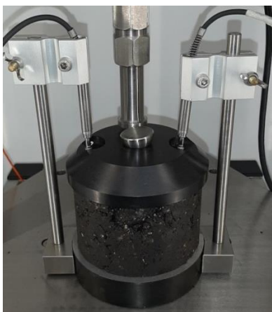
Figura 8. Equipamiento para ensayo creep con y sin contención lateral.
