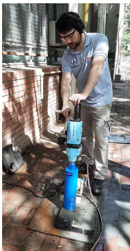
Figura 17. Procedimiento de calado de probetas de 10 cm de diámetro con refrigeración.
