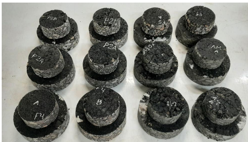
Figura 19. Resultado final de calados de las 8 probetas analizadas.
