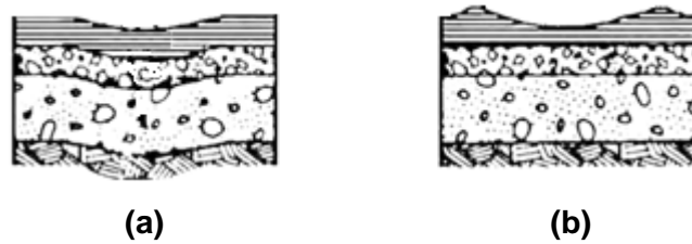
Figura 5. Def. permanente/subrasante débil (a), ahuellamiento/mezcla asfáltica débil (b). [9]
