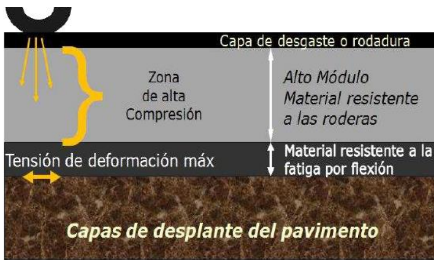
Figura 22. Esquema de pavimento perpetuo.
