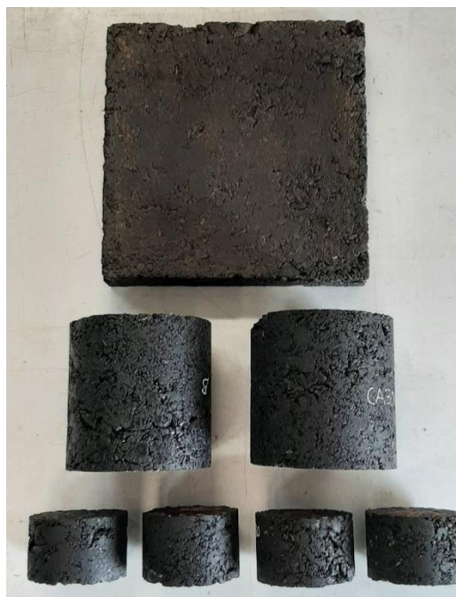
Figura 14. Apariencia de probetas compactadas en laboratorio según rodillo, giratorio y Marshall.
