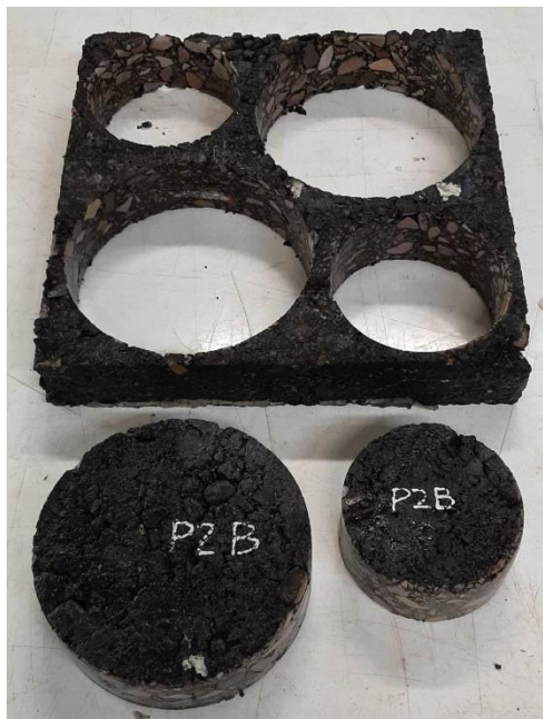
Figura 18. Calados de 10cm y 15 cm de diámetro a partir de probeta de WTT.
