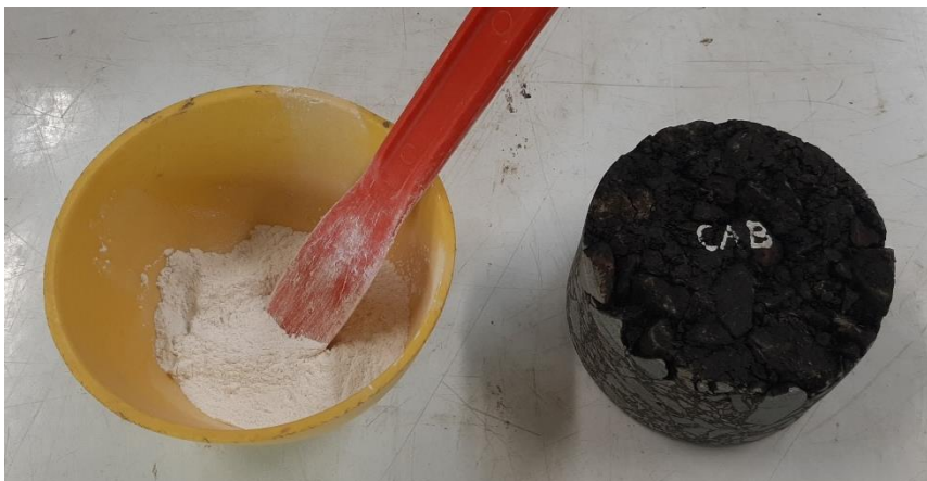
Figura 20. Mezcla de yeso para regularizar superficie.
