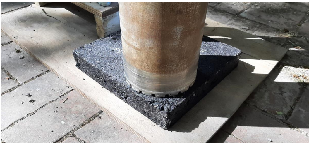
Figura 15. Calado de probetas de 15 cm de diámetro.
