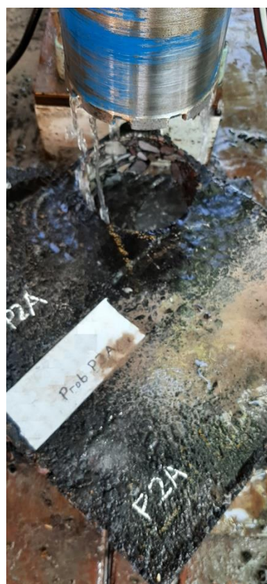
Figura 17. Procedimiento de calado de probetas de 10 cm de diámetro con refrigeración.
