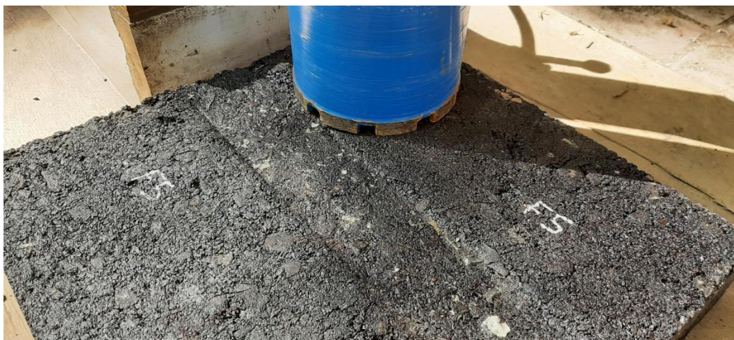
Figura 16. Calado de probetas de 10 cm de diámetro.
