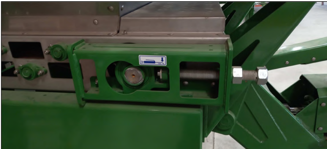
Imagen 4-6: Caja tensora de cinta alimentadora
