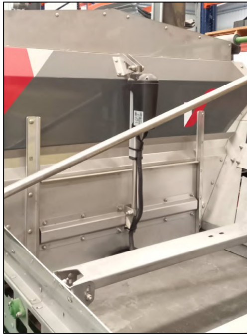
Imagen 4-8: Actuador eléctrico y compuerta trasera
