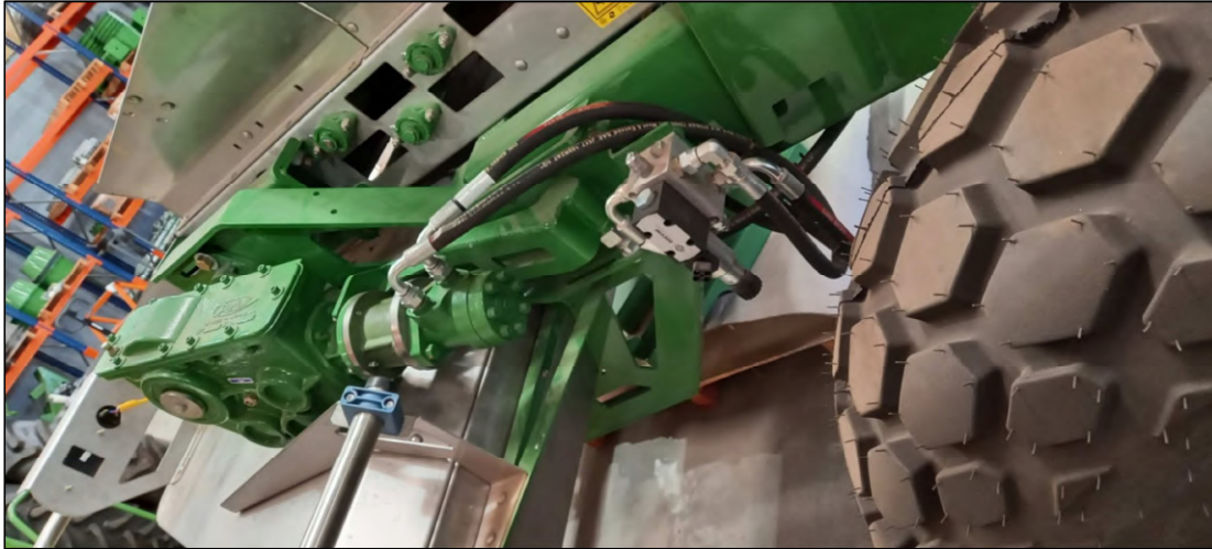
Imagen 4-5: Accionamiento hidráulico de cinta alimentadora
