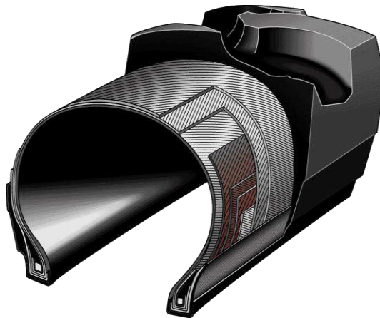
Figura 5-3: Esquema de neumático convencional [14].
