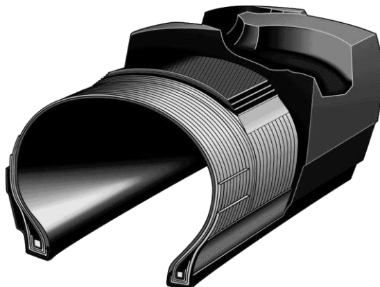
Figura 5-4: Esquema de neumático radial [14].
