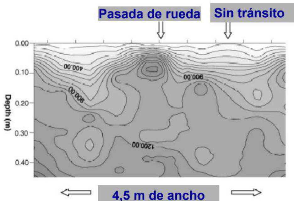
Figura 2-2: Esquema de aumento de índice de cono en zonas de pisado de maquinaria [2].
