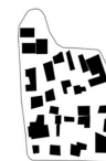
MANZANA REMANSO VALERIO Densidad: 2.696,9 hab/Km 2 Sup. manzana: 8.852 m 2 Sup. construida: 5.058 m 2 FOT: 0,57 FOS: 0,49
