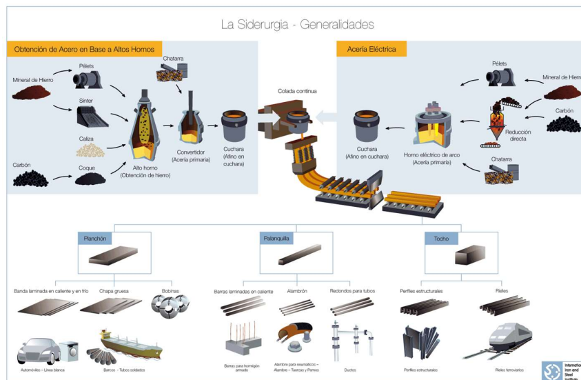
Figura 1. Proceso de producción de acero y posterior utilización para fabricación de piezas.
