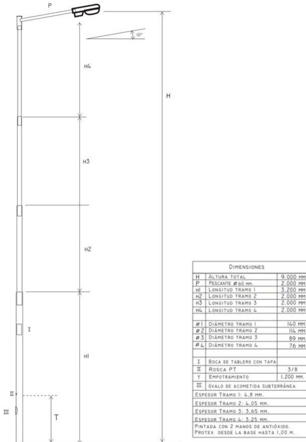
Figura 4-1: Columna 8m con capuchón - Medidas
