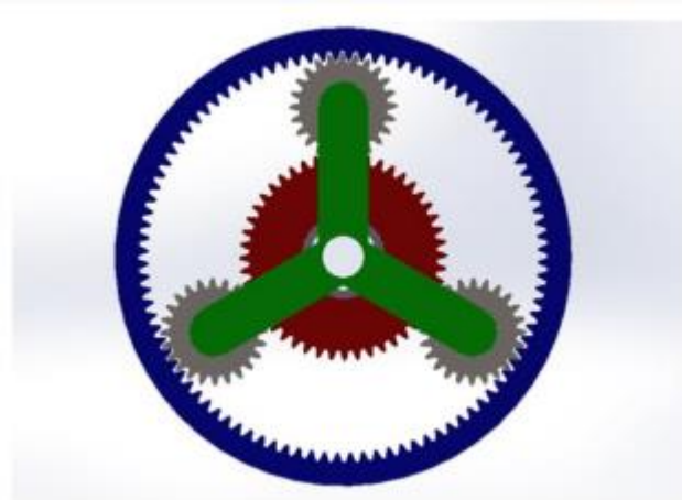
Figura 4-8: Engranaje planetario con el piñón central (rojo) fijo.
