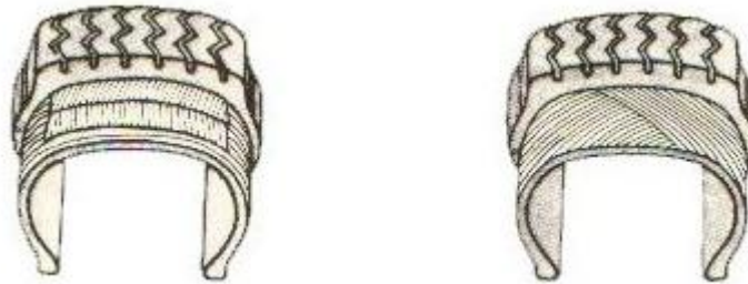
Figura 4-2: Tipos de neumáticos. Radial (izq.) y Diagonal (der.) [12]:
