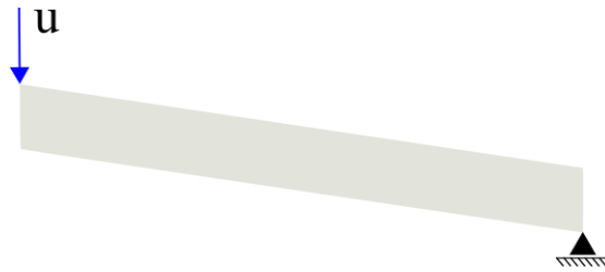
Figura 6- Esquema del modelado axisimétrico del resorte Belleville.
