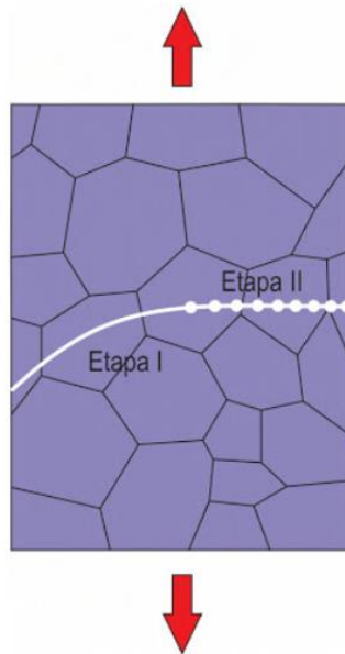
Fig. 1.23. Representación esquemática mostrando las etapas I y II de la propagación por fatiga de una grieta en un metal policristalino [89].
