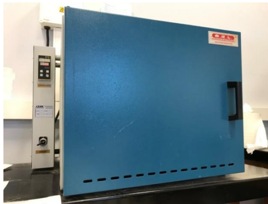
Fig. 2.8. Horno mufla O.R.L.
