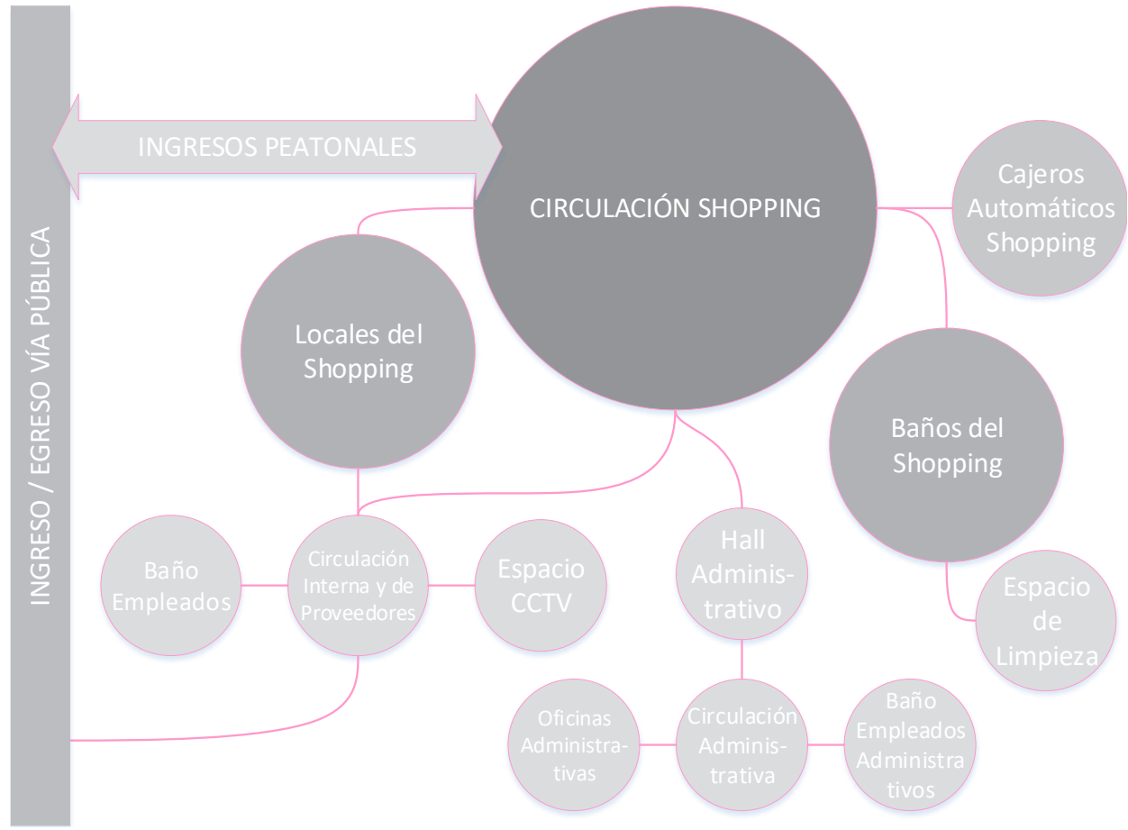
Figura 42: Estudio pormenorizado del diagrama de función arquitectónica para un Paseo Comercial.
