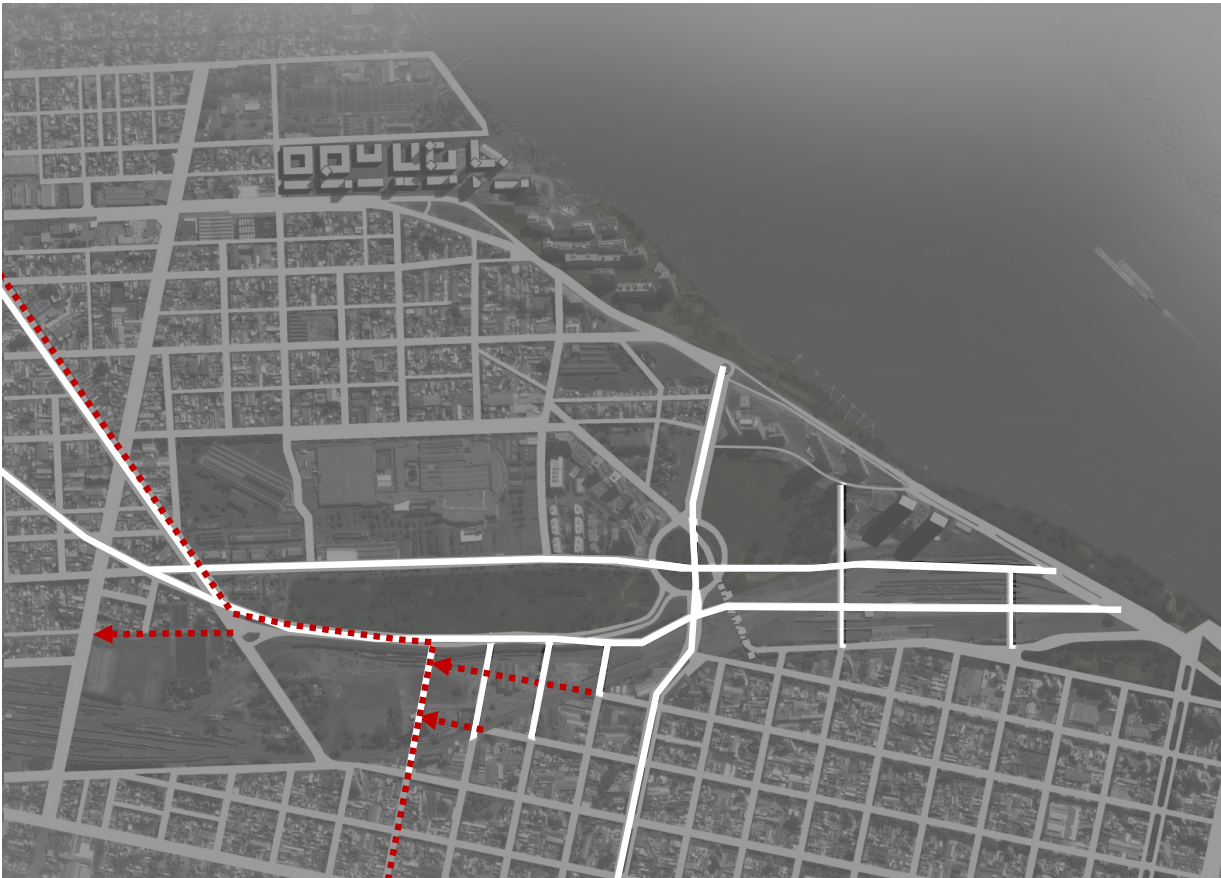
Figura 20: Esquema de apertura propuesta de trazados viales como estrategia de redireccionamiento de los flujos vehiculares en Cruce Alberdi
