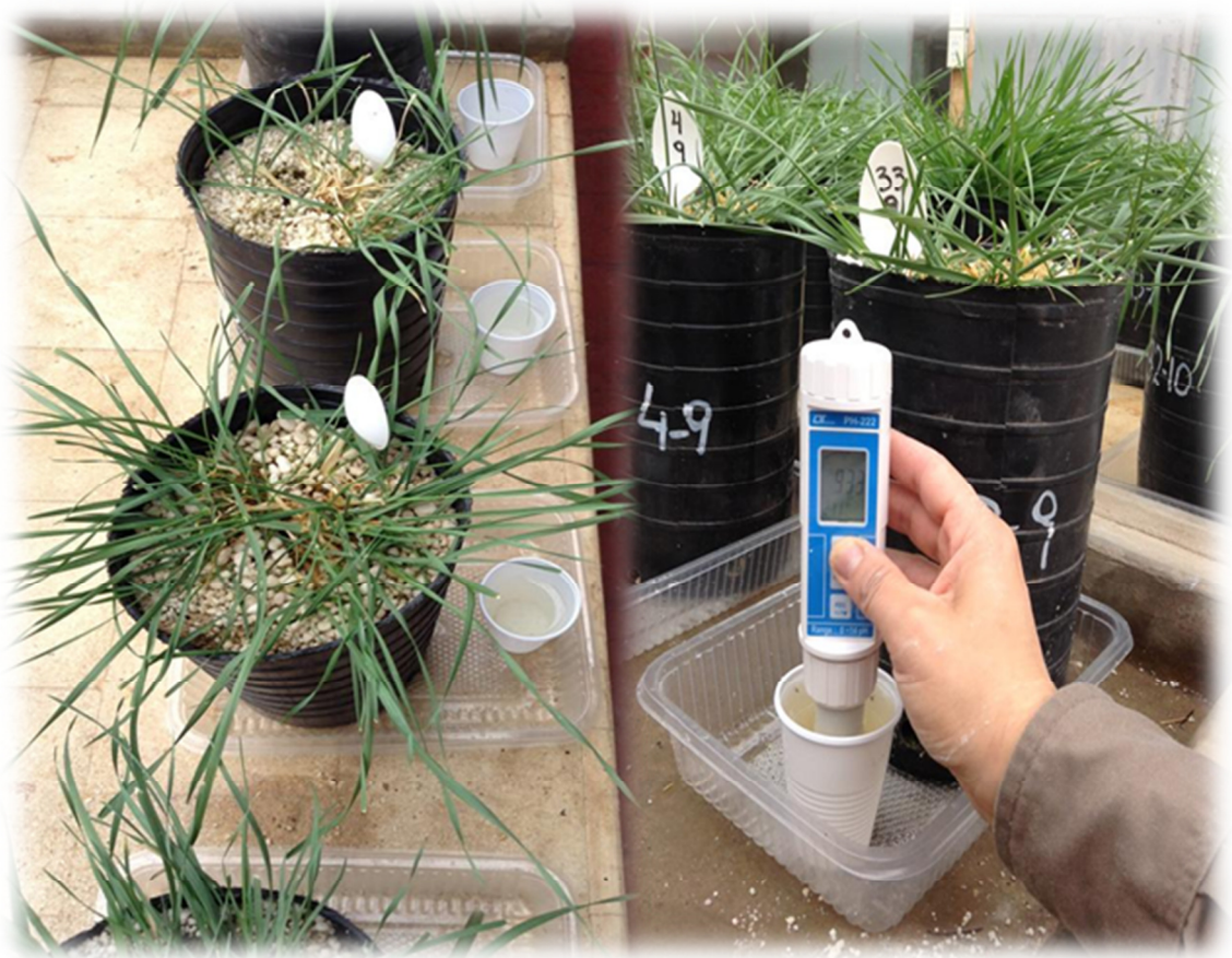
Foto 3.2: Colecta y monitoreo (pH y CE) de solución de drenaje en cada maceta.
