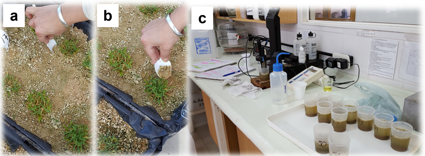
Foto 4.3: a) y b) Muestreo y monitoreo de CE (dS m -1 ) y c) medición en mesada de pH de los sustratos muestreados en los cajones.
