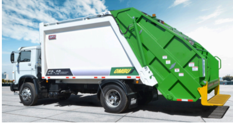
Figura 45. Camión compactador con capacidad de 18 m 3 . Fuente: Google imágenes
