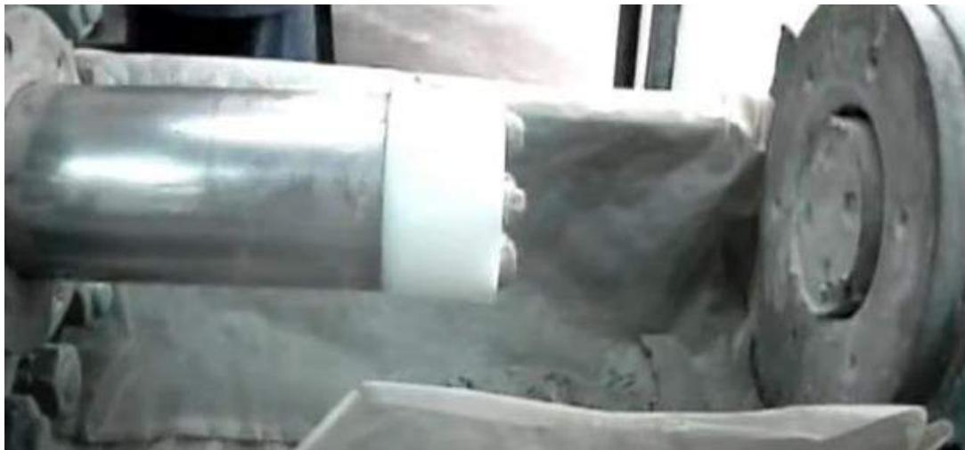
Figura 2-24: Briqueta colocada en el interior del cilindro hidráulico para posterior extrusión. Fuente: ¿QUE Y COMO SE HACE? - Cómo se hacen los ELECTRODOS?
