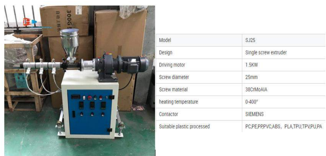
Figura 2-15: Extrusora de laboratorio usos generales monohusillo. Fuente: Brabender
