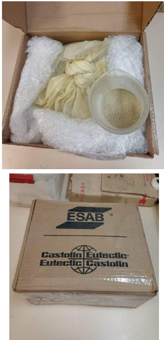
Figura 2-82: Polvo para recubrimiento de electrodo rutílico E6013 marca ESAB
