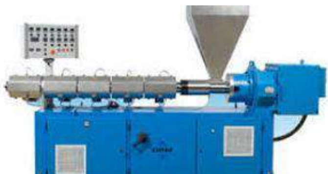
Figura 2-66: Ejemplo de colocación de resistencias eléctricas en una extrusora.
