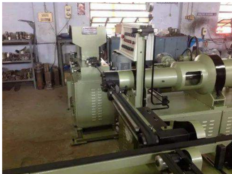
Figura 2-29: Extrusor hidráulico. Fuente: Omega Welrod Systems
