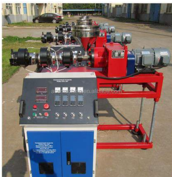
Figura 2-18: Máquina extrusora de laboratorio monohusillo (PVC, ABS, PLA, etc). Fuente: Shuzou ACC Machine Co.
