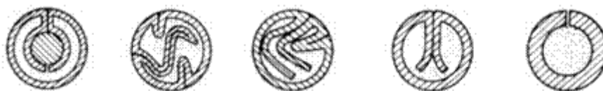
Figura 2-3: Configuraciones para alambres tubulares.
