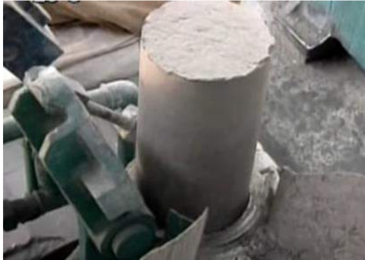
Figura 2-23: Briqueta de pasta para recubrimiento de electrodos. Fuente: ¿QUE Y COMO SE HACE? - Cómo se hacen los ELECTRODOS?
