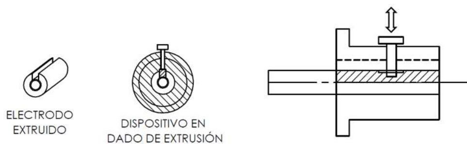
Figura 3-12: Detalle del dado de extrusión.
