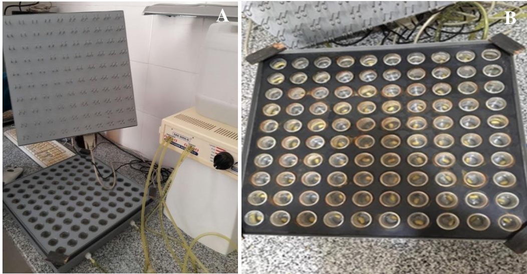
Figura 7 A- Dispositivo de medición de conductividad eléctrica conformado por 100 celdas y sus respectivos electrodos de medición. B- placa de celdas contenedoras de semillas individuales.
