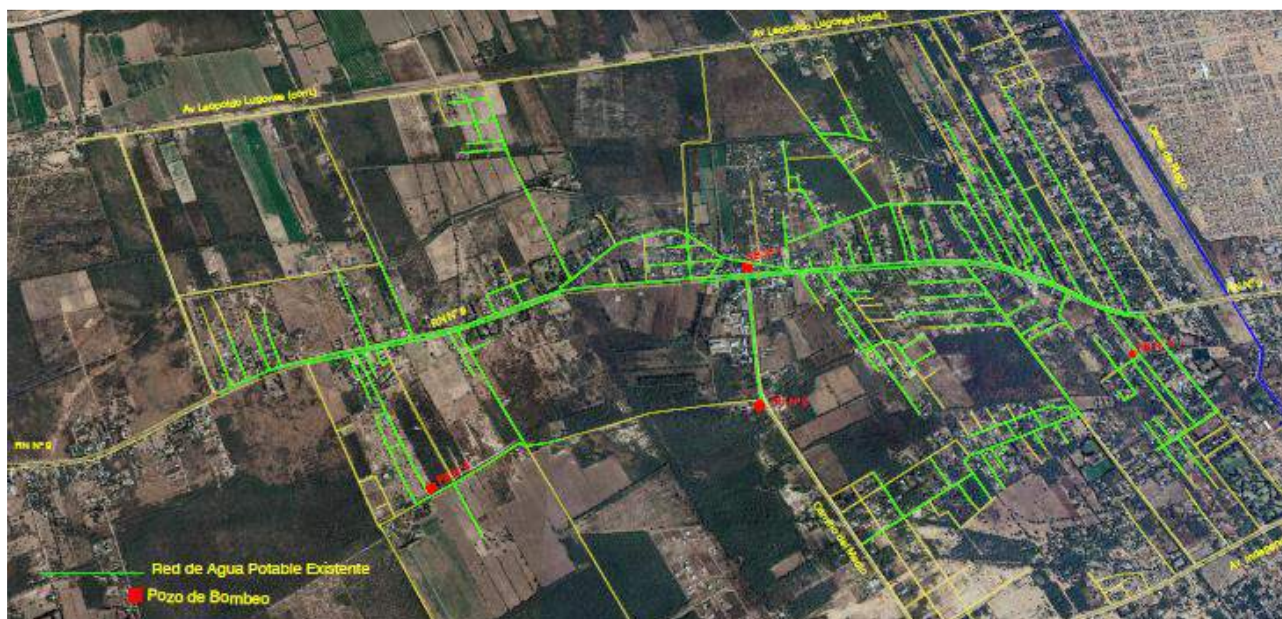
Figura 24 - Red de Agua Existente.
