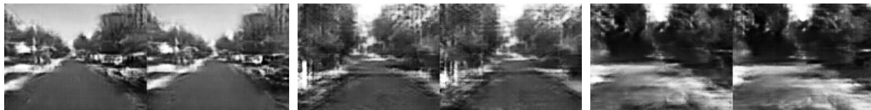
Figura 5.3: Ejemplos de pares de frames generados por el Generador de WGANVO. En cada par se observa un ligero desplazamiento que representa el movimiento de la cámara.
