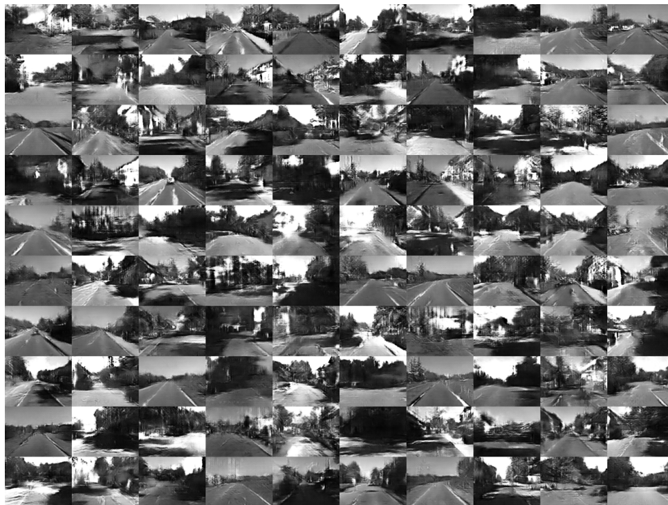
Figura 5.4: 100 imágenes generadas por la red generativa de WGANVO para distintos valores del vector aleatorio z que toma el Generador por entrada. Dado que se generan pares de imágenes, en este caso estamos observando las imágenes correspondientes al primer elemento del par.
