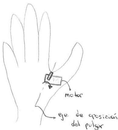
Figura 3-32: Croquis de opción 2 para movimiento de oposición del pulgar.
