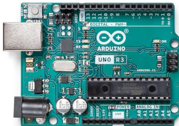
Figura 3-43: Placa Arduino 1, la más robusta, utilizada y documentada de toda la familia Arduino. [22]
