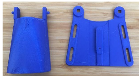
Figura 1-65: Pieza base (izquierda) y pieza a termoformar (derecha). [2]
