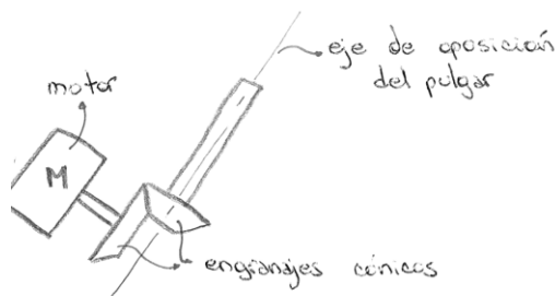
Figura 3-31: Croquis de opción 1 para movimiento de oposición del pulgar.
