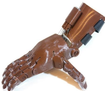
Figura 1-64: nueva versión de la prótesis de mano Phoenix Hand v3. [19]
