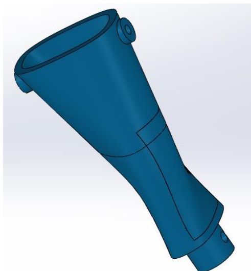
Figura 4-5: Representación de la recomendación para el diseño del antebrazo.
