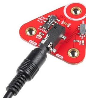
Figura 4-18: SMyoWare® 2.0 Link Shield o escudo de enlace. [29]
