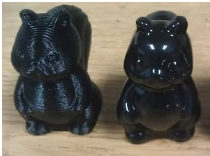
Figura 4-29: Diferencias entre el acabado superficial de la impresión 3D (izquierda) y el obtenido luego del postproceso con baño de acetona (derecha). [23]
