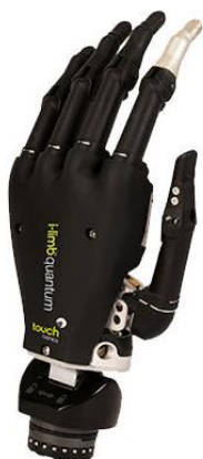
Figura 1-8: Prótesis mioeléctrica i-Limb de la empresa Touch Bionics, recientemente adquirida por Össur. [12]
