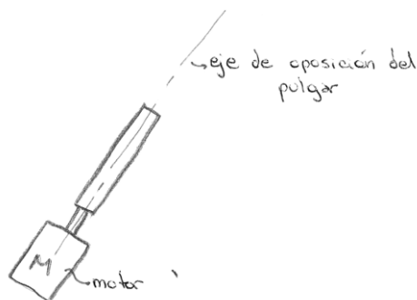
Figura 3-33: Croquis de opción 3 para movimiento de oposición del pulgar.
