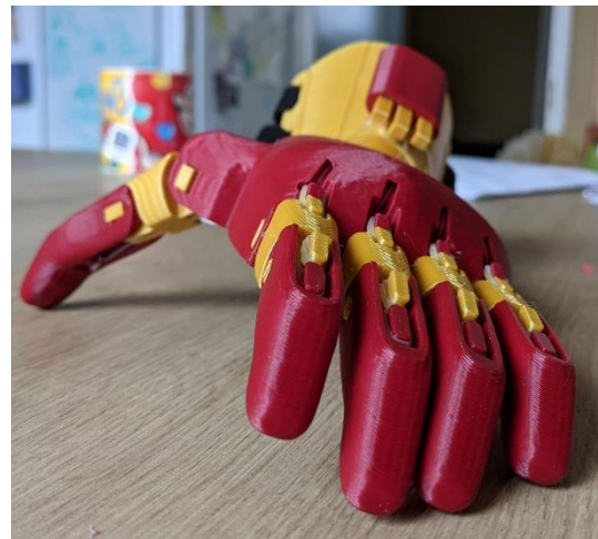
Figura 4-28: Prótesis Phoenix de e-Nable con incorrecta selección de orientación de las falanges de los dedos. [19]
