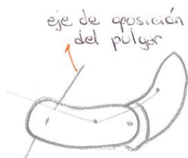
Figura 3-29: Croquis de pulgar con dos falanges comandado mediante cable.
