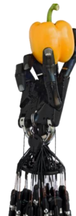
Figura 1-7: Mano robótica Shadow Hand de la empresa Shadow Robot Company. [11]
