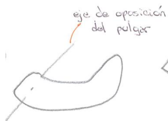
Figura 3-30: Croquis de pulgar de una sola pieza.
