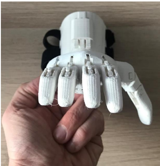
Figura 4-27: Prótesis Phoenix de e-Nable con incorrecta selección de orientación de las falanges de los dedos. [19]
