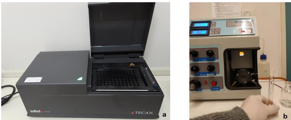
Figura 18. Lector de placas TECAN F50 ™ utilizado para la determinación de proteínas totales (a). Fotómetro de llama Zentec ZF ™ 2500, utilizado para la determinación de sodio y potasio (b).
