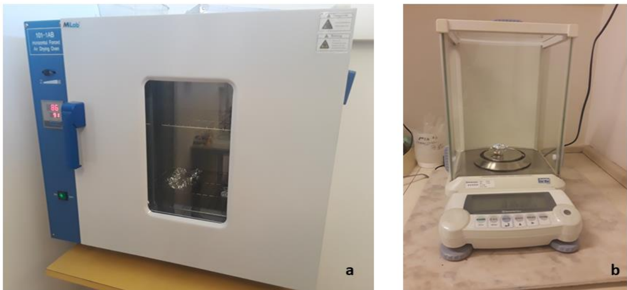
Figura 16. Equipos utilizados para la determinación de sólidos totales. Muestras de moco cérvico-vaginal en canastas papel aluminio, en horno de secado de aire forzado horizontal (a). Pesaje de las muestras en balanza analítica (b).
