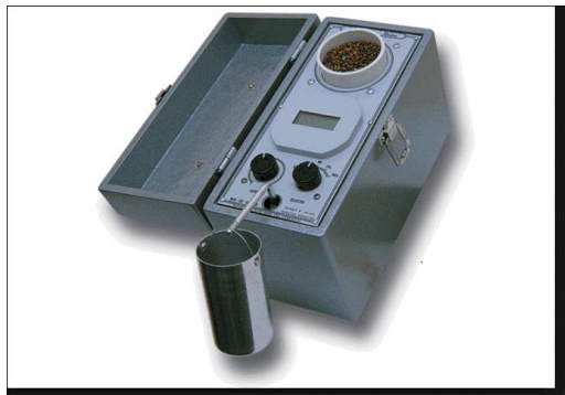
Figura 17. Imagen de Higrómetro Delver, modelo HD1023, utilizado para medir temperatura y humedad de las semillas cuando fueron tomadas las correspondientes muestras para ser enviadas a laboratorio.
