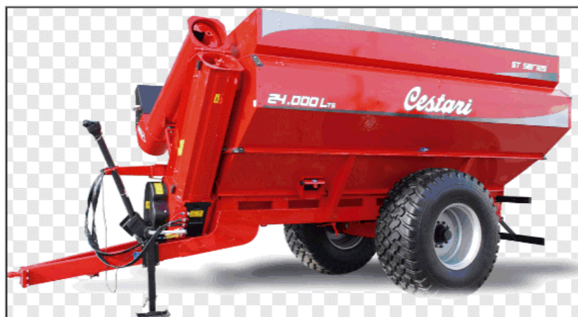
Figura 10. Tolva autodescargable marca Cestari Serie ST capacidad 24.000l, utilizada para transportar la semilla desde la cosechadora a la embolsadora.
