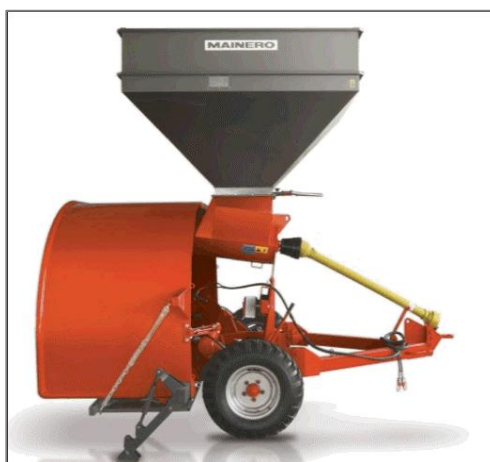
Figura 11. Máquina embolsadora marca Mainero modelo 2230, empleada para el llenado del silo-bolsa en la campaña 2014-2015.
