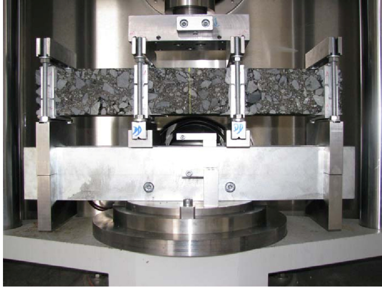
Figura 7 - Ensayo de viga a flexión en 4 puntos [23].
