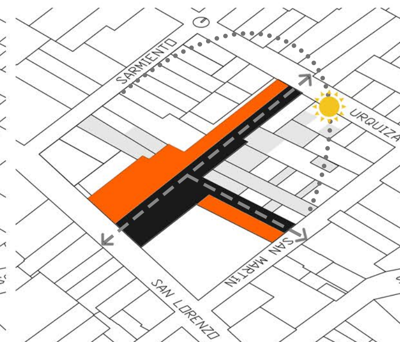
● VOLUMENES APOYADOS EN MEDIANERAS OESTE Y SUR. (VISUALES NORTE Y ESTE)
