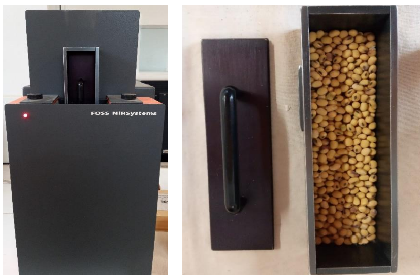
Figura 5. Equipo de análisis NIR con celda de muestras de semillas de soja
