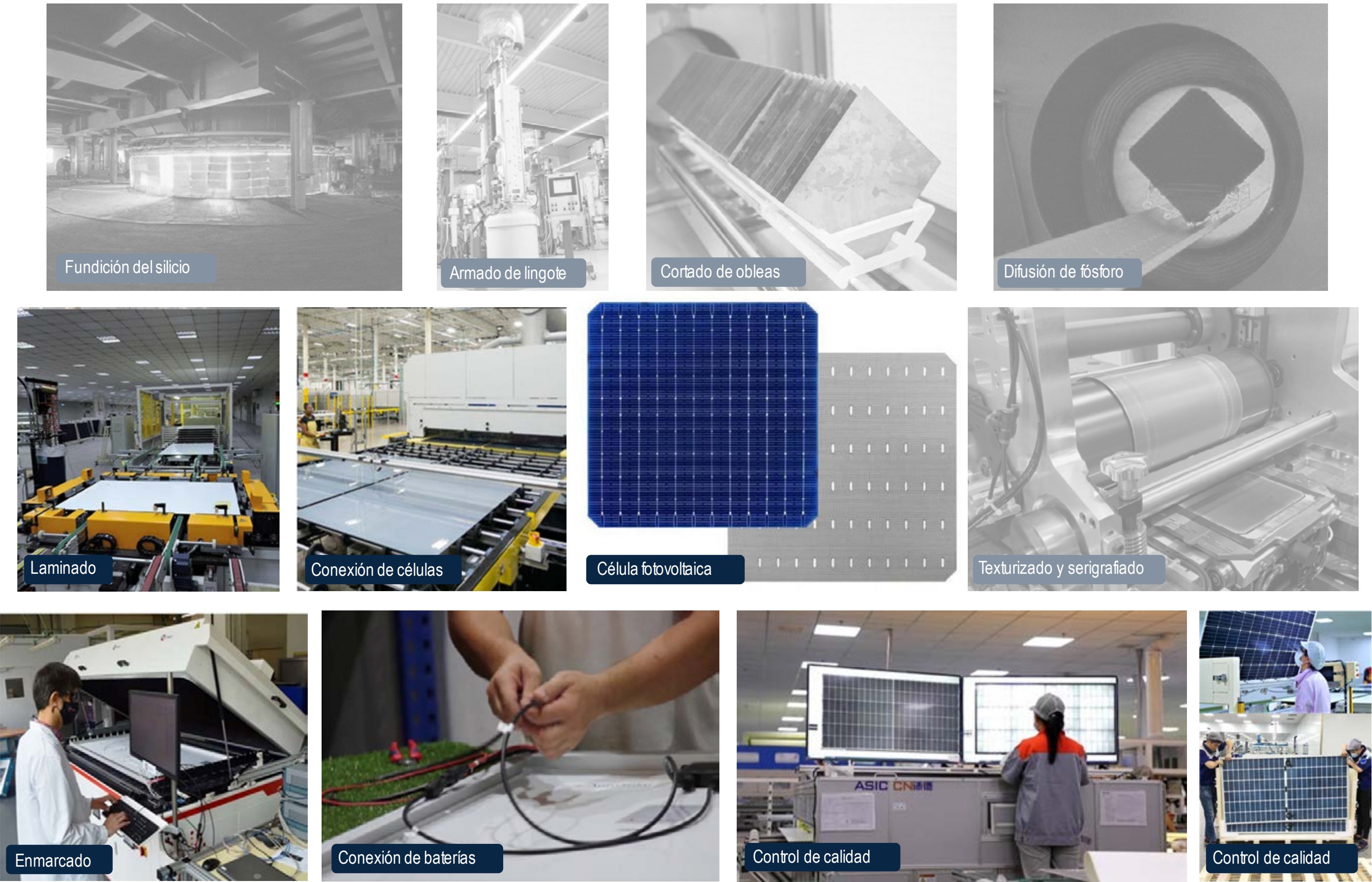
Fig.64 -Proceso de producción del armado del panel solar.
