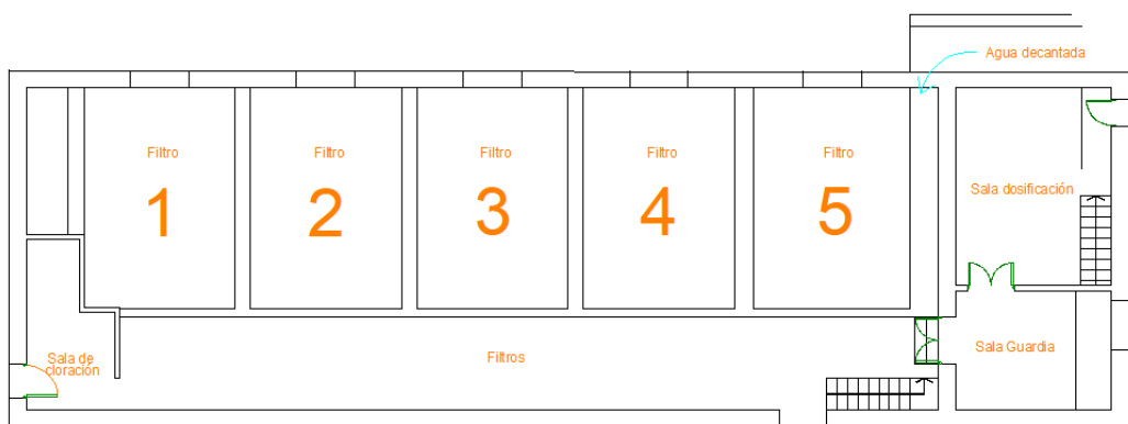
Figura 23: Vista superior filtros rápidos. Planta potabilizadora Fuente: Elaboración propia
