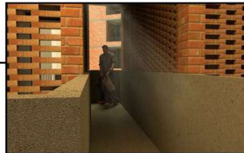
PERFORACIÓN PARA VENTILACIÓN CRUZADA
