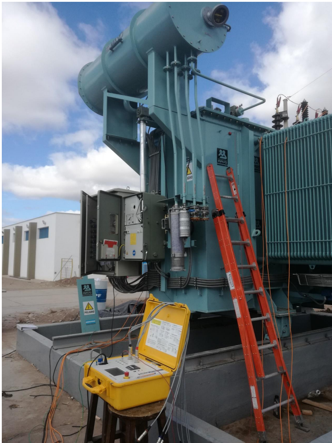
Figura 4-6: Medición de la resistencia de los arrollamientos con el Analizador de arrollamientos
