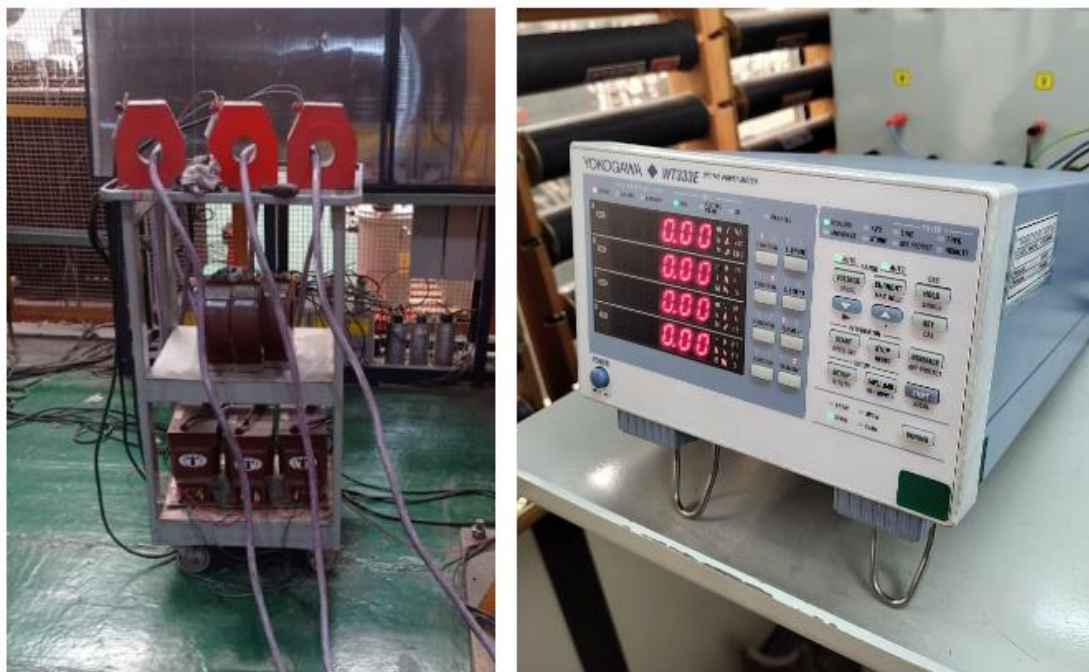
Figura 4-5: Banco de medición y transductor de potencia.
