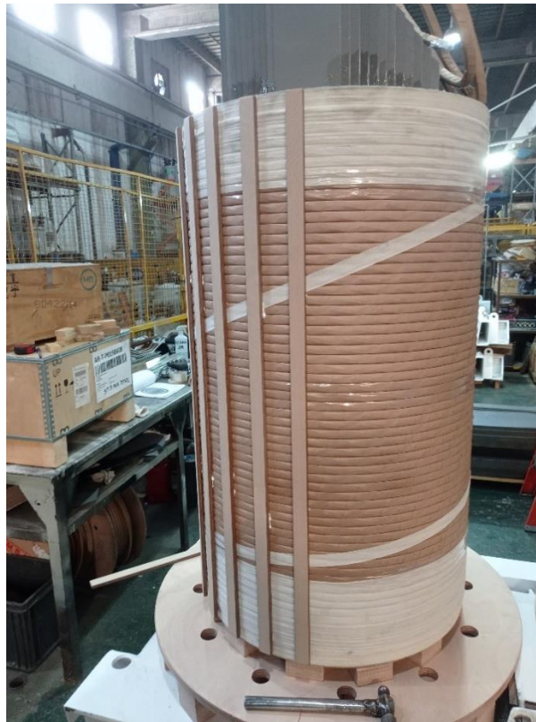
Figura 2-3: Bobina de baja tensión durante montaje.
