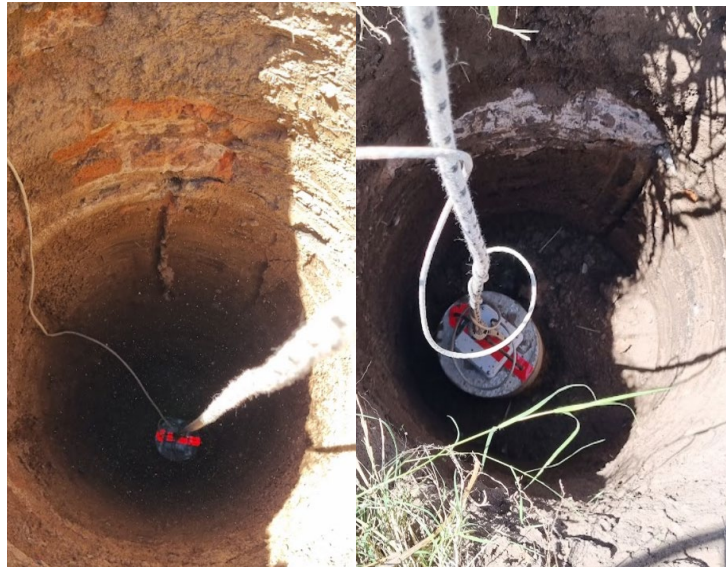
Figura 17: Implantación de acelerómetros en los pozos.
