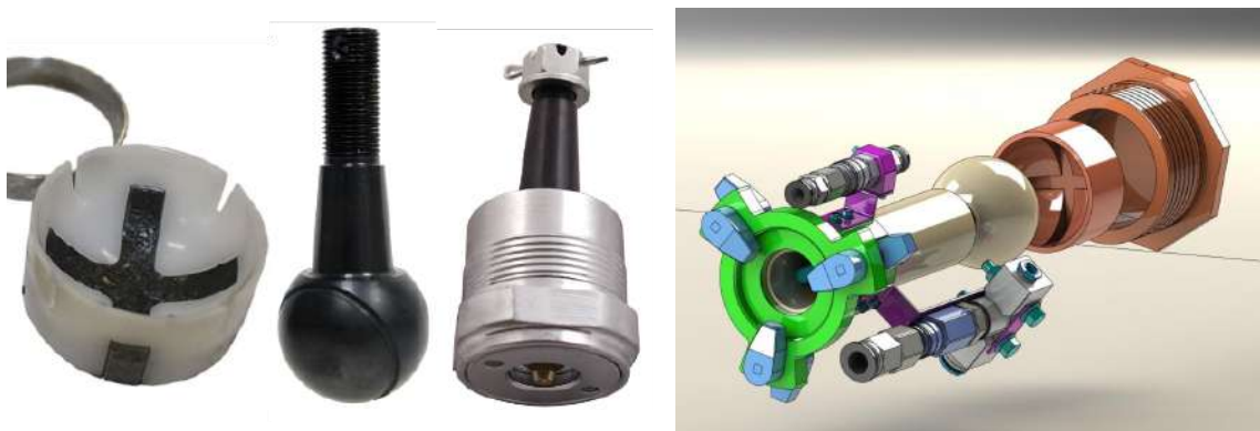
Figura 2-20: El diseño se basa en las rótulas de automóviles.
