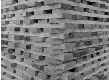
Figura 51. Forma típica de cómo se dispone las secciones de madera para su posterior secado en aserraderos.
