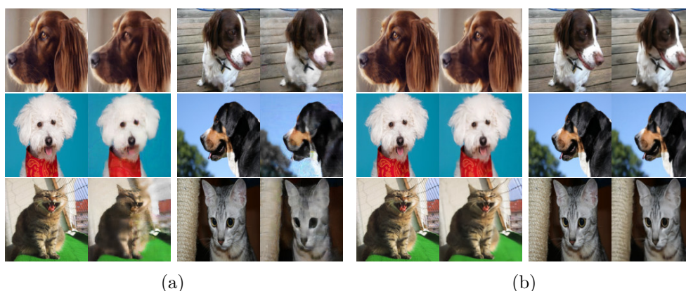
Figura 6.10: Reconstrucciones al invertir imágenes hasta el espacio de la primera capa densa respecto al MSE (a), incorporando la modificación del gradiente de las ReLUs en (b).
