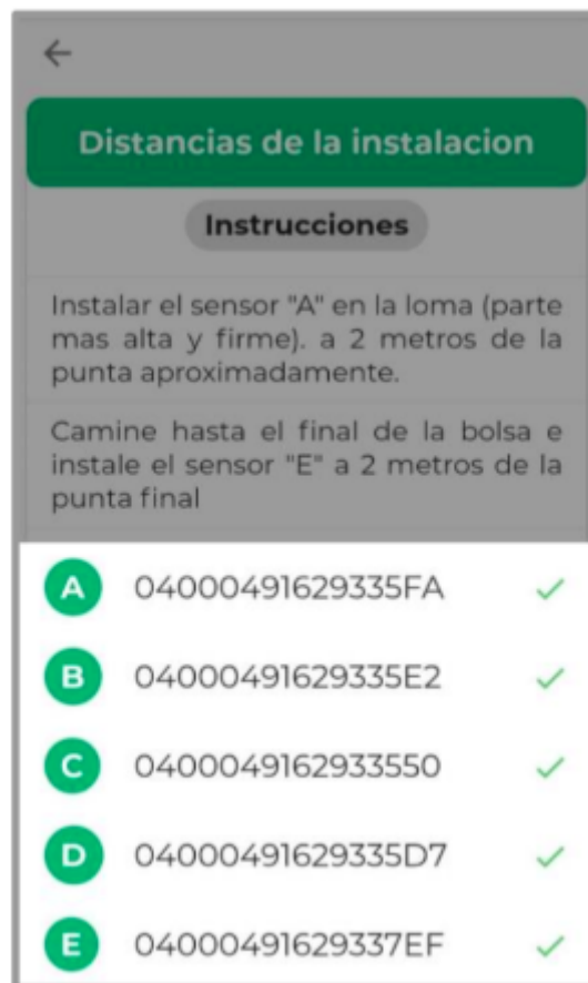
Figura 56: Aplicación de instalación, activación de sensores.
