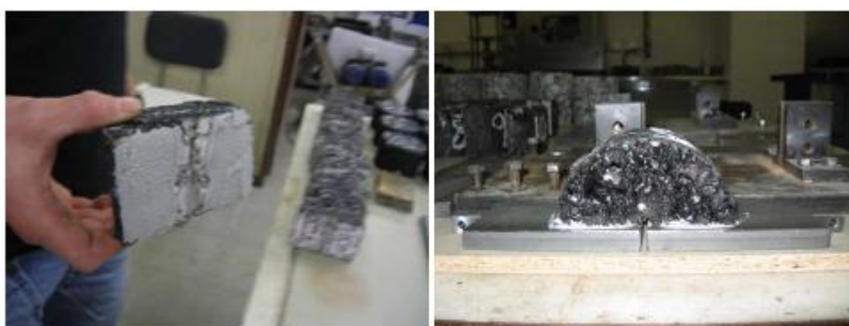
Figura 41 - Fabricación de probeta Fénix, pegado de placas metálicas (Valdés Vidal, 2011)
