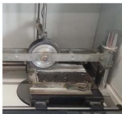
Evaluación de la Resistencia al Ahuellamiento
