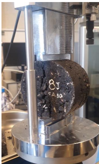
Figura 51 - Imagen de rotura a la tracción indirecta de la probeta N°8 CAC D19 CA30 4,6%
