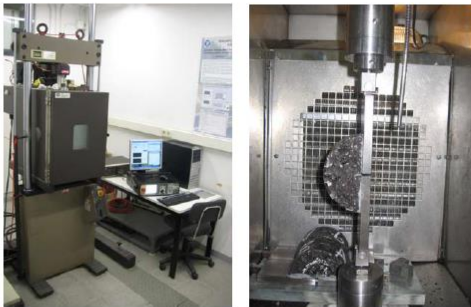
Figura 42 - Montaje ensayo Fénix en prensa MTS con cámara ambiental (Valdés Vidal, 2011)
