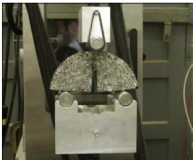
Figura 35 - Montaje y esquema del ensayo SCB (Huang B., 2004)
