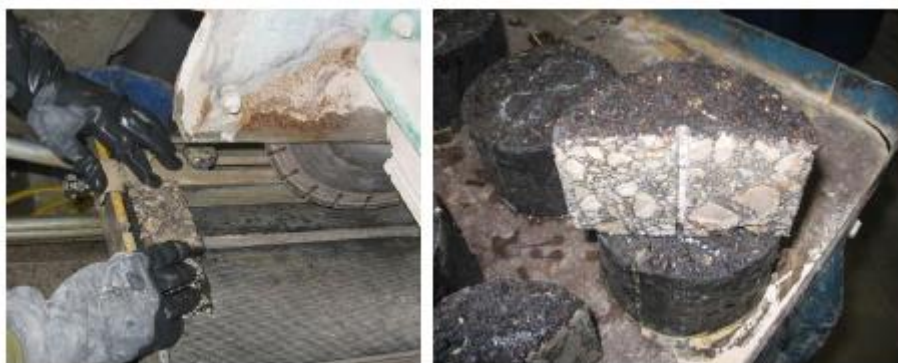
Figura 40 - Fabricación de probeta Fénix, corte e inducción de fisura (plano diametral de corte) (Valdés Vidal, 2011)
